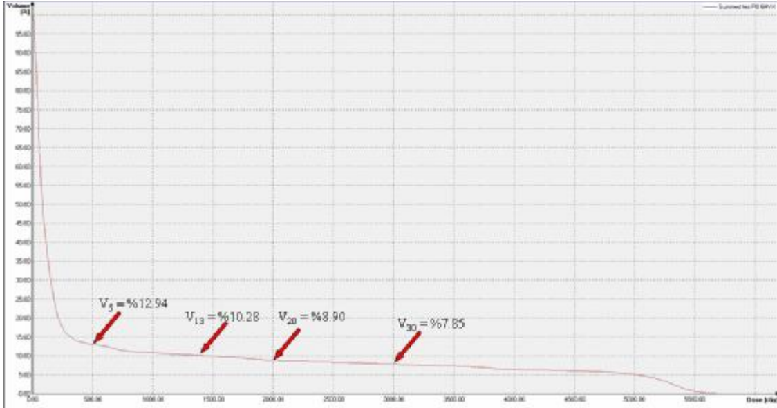
Şekil 4. Örnek bir olguda 6MVX foton enerjisinde PB algoritması kullanılarak hesaplanmış planın DVH'i üzerindeki V_5 , V_{13} , V_{20} ve V_{30} parametrelerinin gösterimi.
