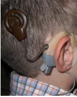
Şekil 12. Cochlear Nucleus Freedom BTE konuşma işlemcisi+ Phonak mLxi Dinamik FM alıcısı
