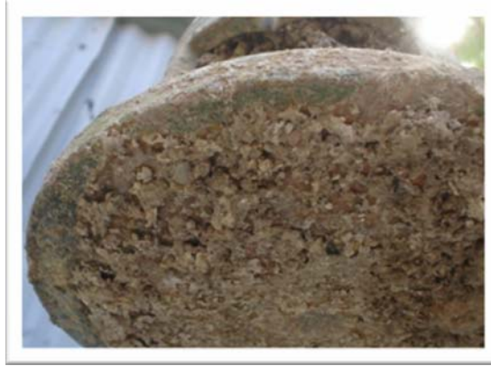
Resim 5: Tabanda oluřan kalker tabakası
