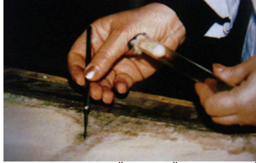
Fotoğraf 31: Yazma Eser Üzerinden Örnek Alınması İşlemi Kaynak: A. Yücel-A.S. Kantarcıoğlu (1997)
