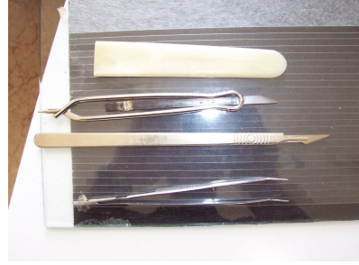
Fotoğraf 57: Kâğıt Onarımında kullanılan bıçak, ıskata, bisturi, cımbız Foto: Serkan İlden
