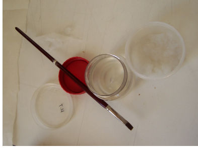
Fotoğraf 56: Yapıştırıcı olarak kullanılan CMC, Nişasta kolası ve fırça Foto: Serkan İlden
