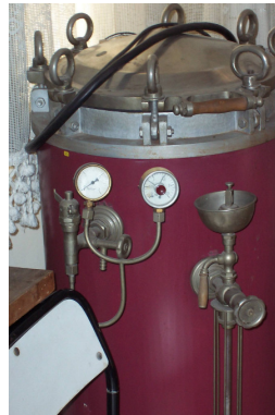
Fotoğraf 30: Vakumlu Fümigasyon Cihazı Foto: Serkan İliden
