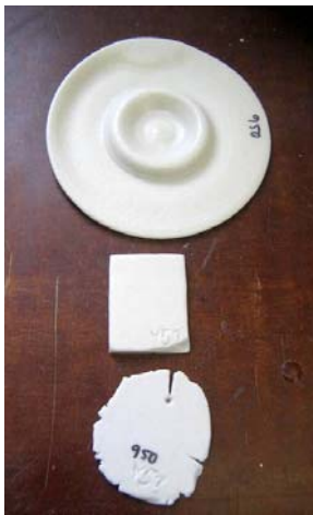
Resim 18: Aynı fritli hamurun farklı sıcaklıklardaki sonuçları
