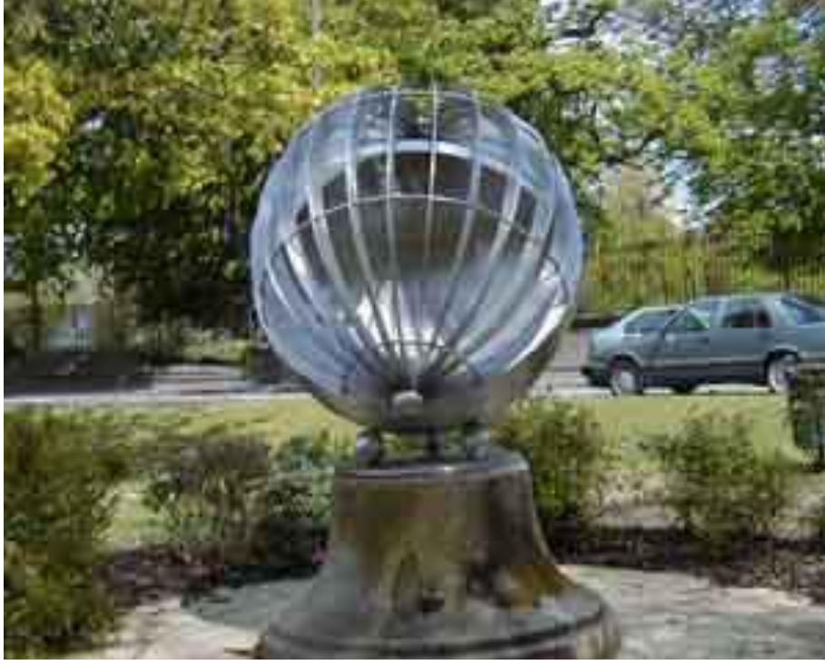
Resim: Yine İngiltere’de yer alan bir Güneş saati. Kadran bir küre kesitidir.
