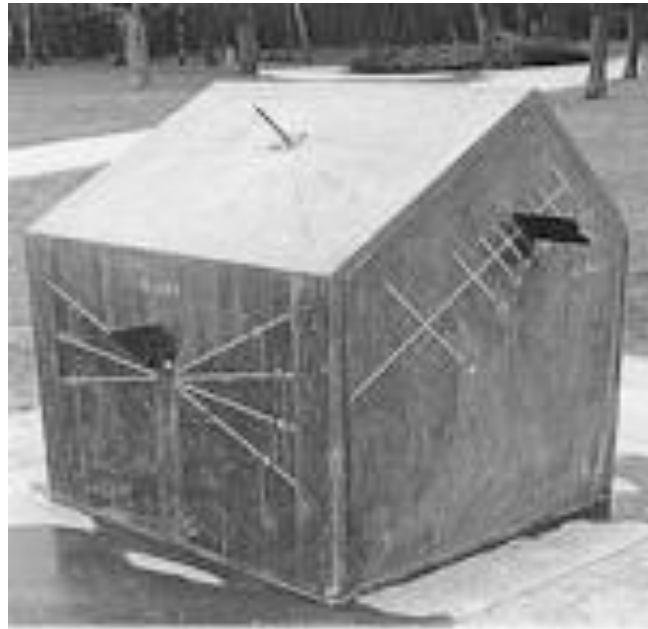
Resim: Bu tipteki dikey kadranlı bir Güneş Saatinin şematik gösterimi ve gerçek bir modeli.
