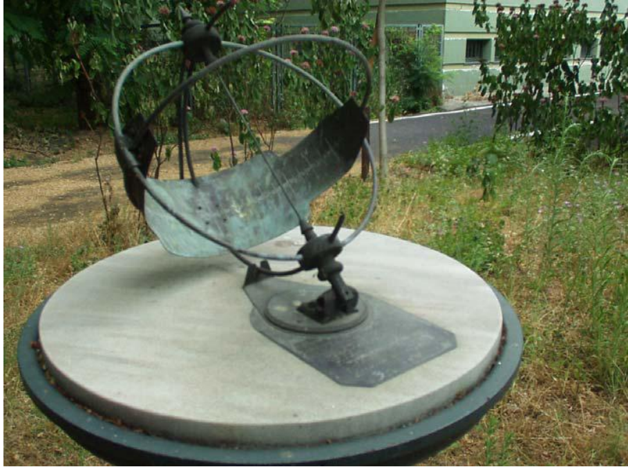
Resim: İstanbul Üniversitesi’nde yer alan kutup Güneş saati. Dikkat edilirse kadran silindriktir.
