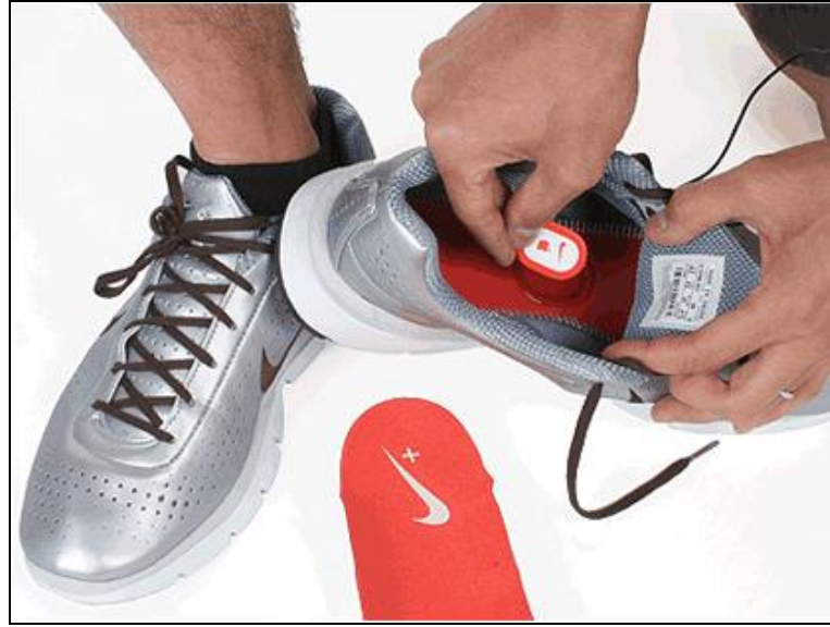
Resim 101: Koşu esnasında müzik dinlemeyi de sağlayan Nike + iPod Sport Kit spor ayakkabısı. Ayakkabının içine yerleştirilen iPod sayesinde hem müzik dinlemek hem de zamanı, mesafeyi ve kaloriyi ölçmek mümkün olmaktadır.
