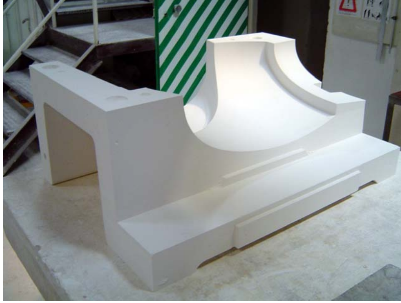
FOTOĞRAF 32: Kalıbın yan parçasının işlenmiş görünümü
