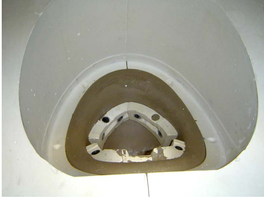
FOTOĞRAF 47: Döküm sonrası üst parça kalıptan ayrıldığında çekirdekler hazne içinde kalır.
