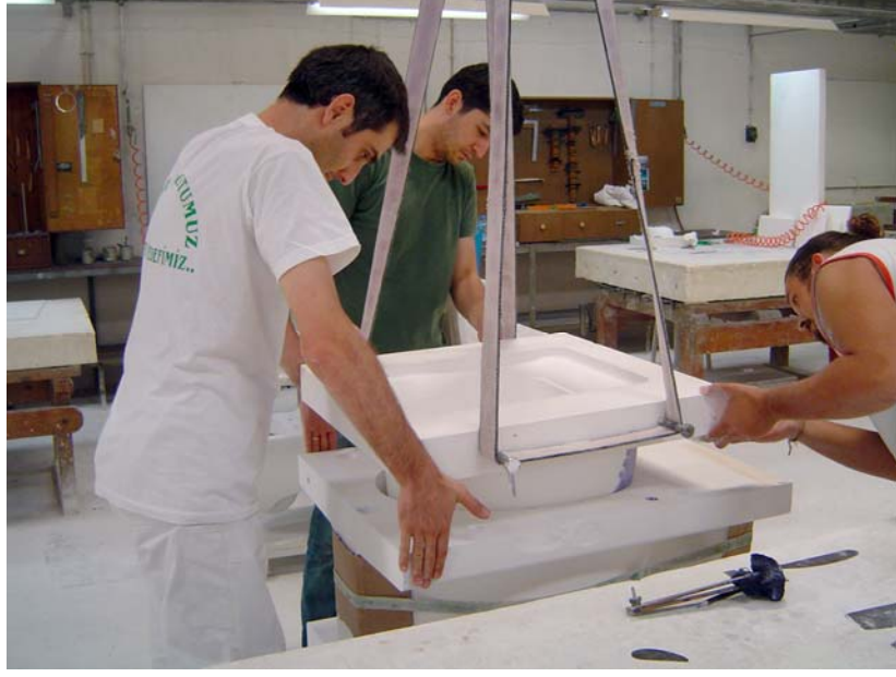
FOTOĞRAF 36: Kalıbın üst parçasının yan parçalara alıştırılması
