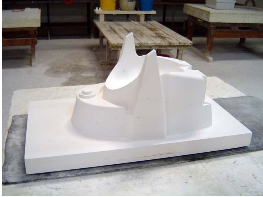
FOTOĞRAF 25: Kalıp arka parçasının işlenmiş görünümü
