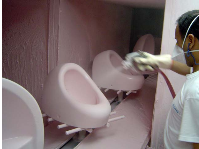
FOTOĞRAF 58: Yüzeydeki ölü bölgeler için gerekli olan manuel sırlama
