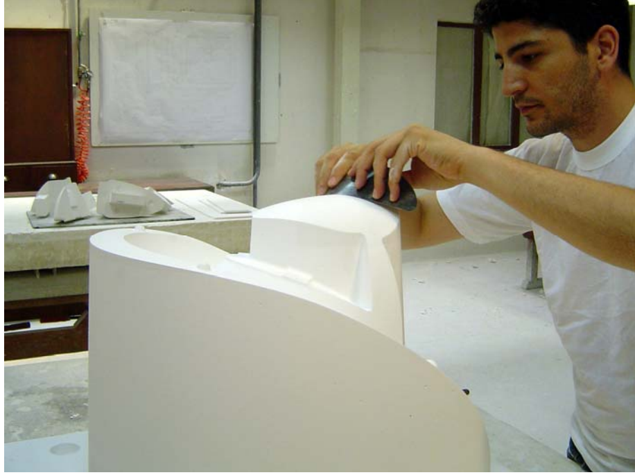
FOTOĞRAF 23: Kalıp parçaları işlendikten sonra küçük rötuşlara tabi tutulabilir.
