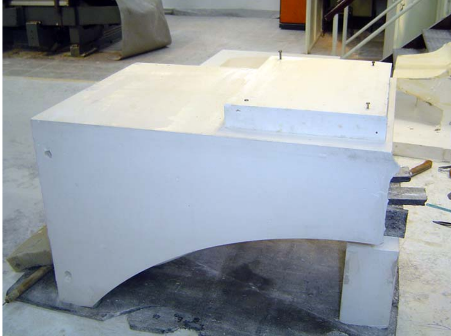
FOTOĞRAF 4: Temiz su haznesi modellenmiş olan maketin kancaları atıldıktan ve bu oluklar alçı ile kapatıldıktan sonra arka bölümü bir alçı plaka yardımıyla kapatılır.
