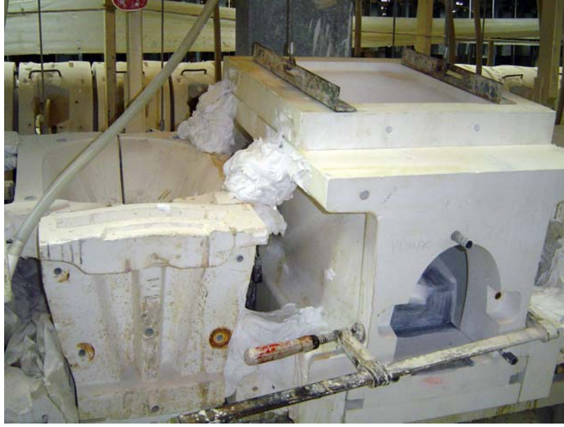
FOTOĞRAF 44: Tezgâhtaki diğerkalıplarla birlikte döküm yapmak için yan parçalar birbirine tutturulur.
