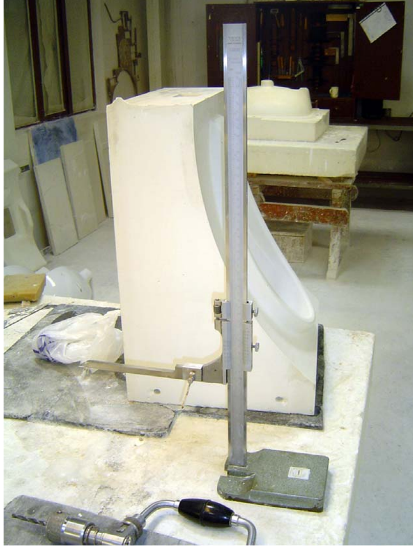
FOTOĞRAF 8: Mihengir yardımıyla maketin ağız kısmından hassas biçimde ölçüler alındı.
