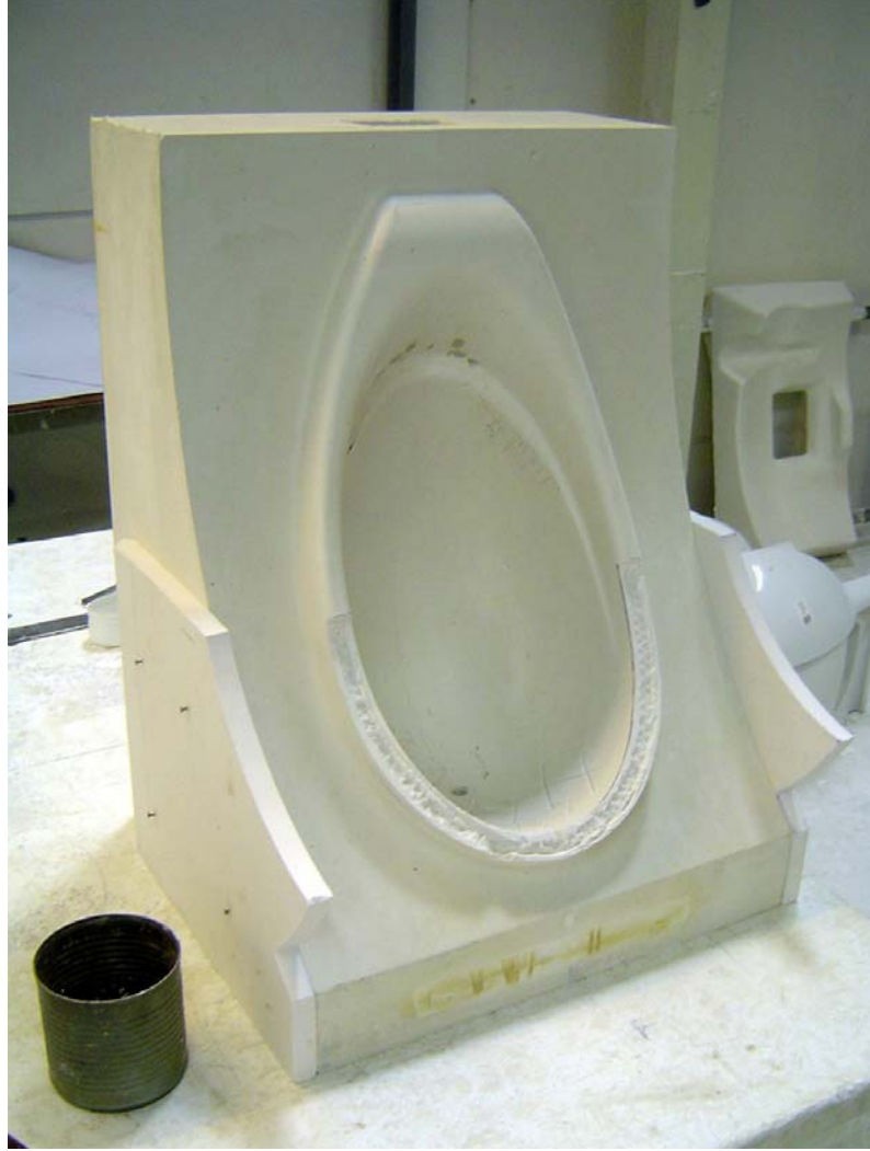
FOTOĞRAF 9: Alınan ölçüler doğrultusunda maketin ağız kısmı kırıldı ve yeni bir ağız oluşturmak için şablonlar hazırlandı.
