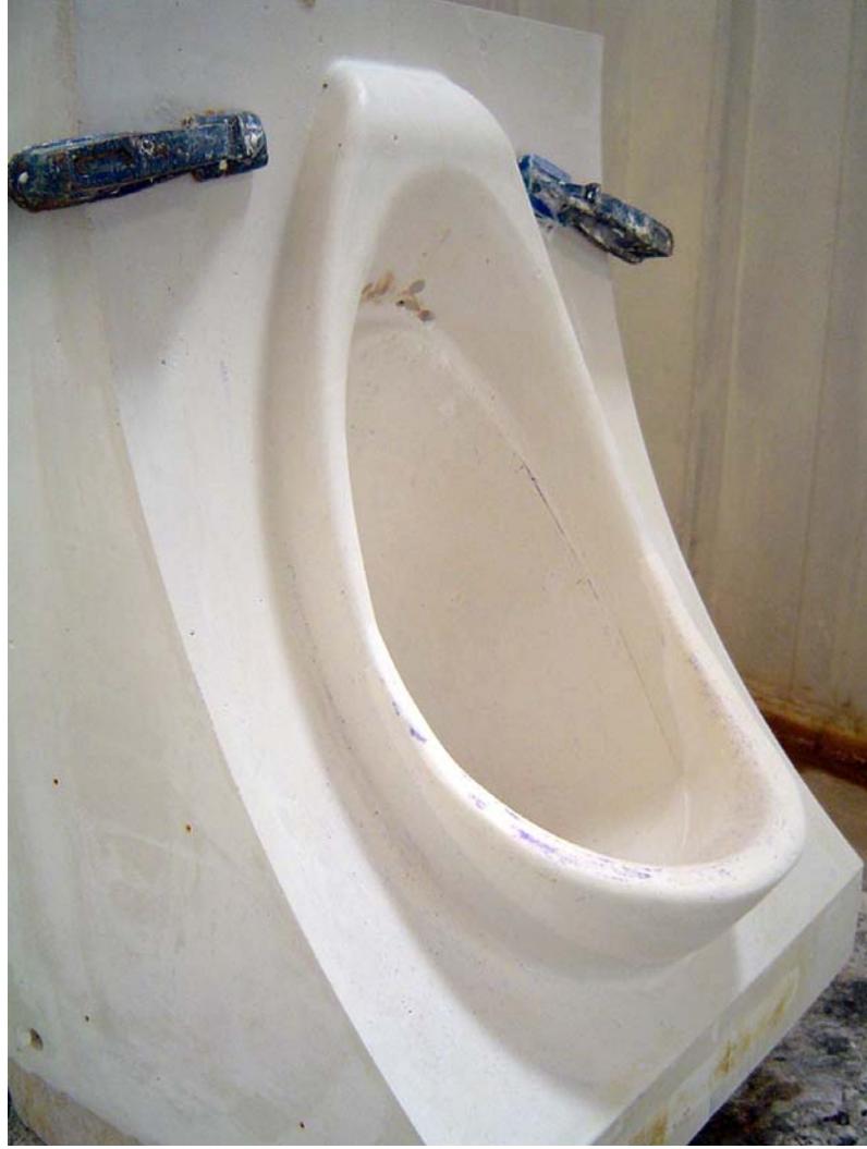
FOTOĞRAF 10: Maketin son olarak fonksiyon testine tabi tutulması
