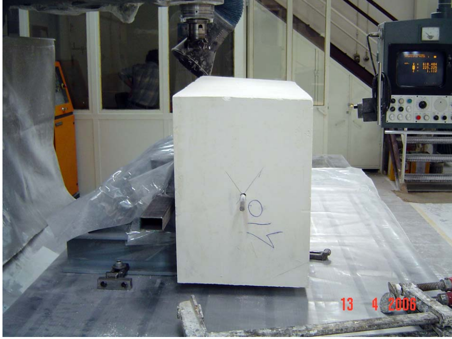
FOTOĞRAF 11: Alçı bloğun CNC tezgâhına yerleştirilmesi
