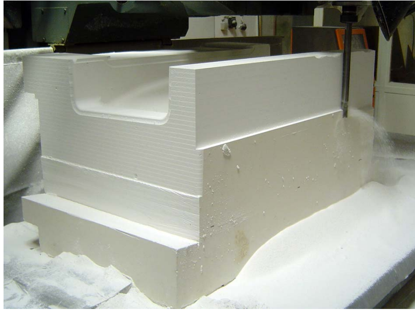
FOTOĞRAF 31: Kalıbın yan parçasının dış yüzeyi işlenirken
