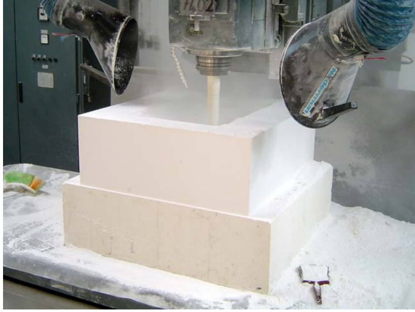
FOTOĞRAF 19: Kalıp üst parçasının CNC' de işlenmesi
