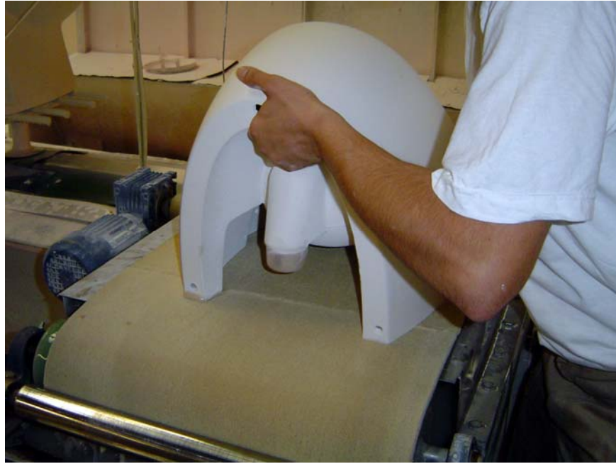
FOTOĞRAF 60: Sırlama sonrasında ürünün pişme yüzeylerinin rötuşlanması. Raflara yüklenen ürün tünel fırında 1200°C'ta 17 saatlik bir sürede pişirilir.
