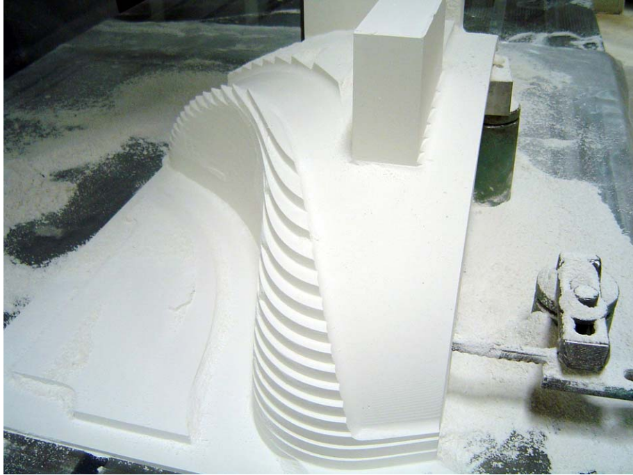
FOTOĞRAF 14: Modelin yan yüzeylerinin işlenmesi
