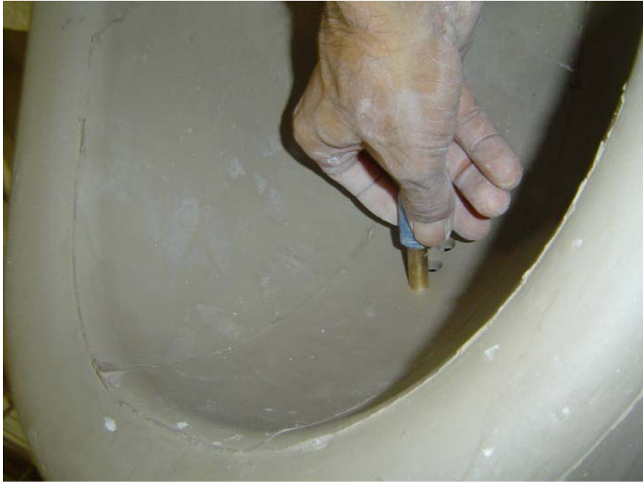
FOTOĞRAF 52: Hazne üzerinde pirinç bir boru yardımıyla pis su deliklerinin açılması
