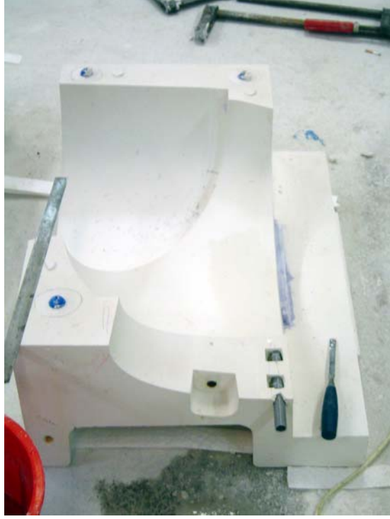
FOTOĞRAF 38: Yan parçalara döküm borularının montajı
