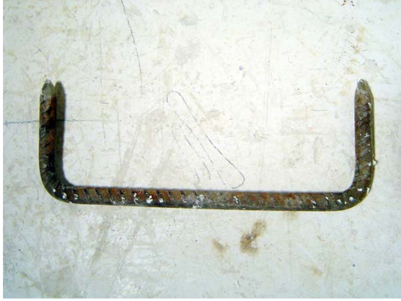
FOTOĞRAF 3: Yivli demir çubuktan hazırlanan kanca
