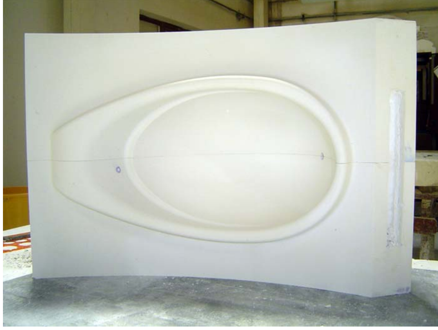
FOTOĞRAF 1: Üç eksenli CNC tezgâhında hazırlanan fonksiyon modeli iki parça halinde işlenmiştir.
