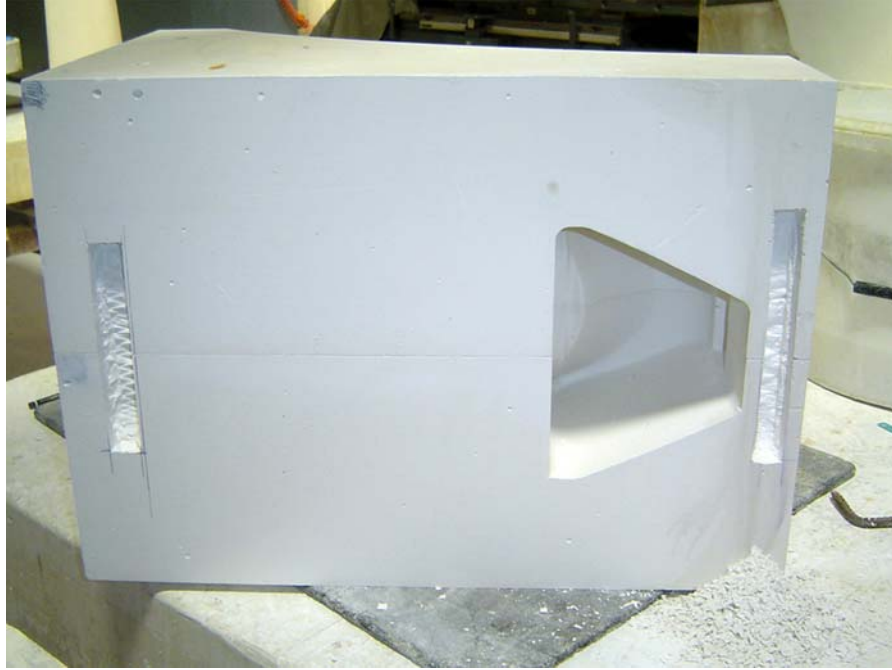
FOTOĞRAF 2: Hazırlanan parçaları birleştirmek için kanca kullanılmıştır. Arkada görülen oluklar kancanın çakılması için açılmıştır.
