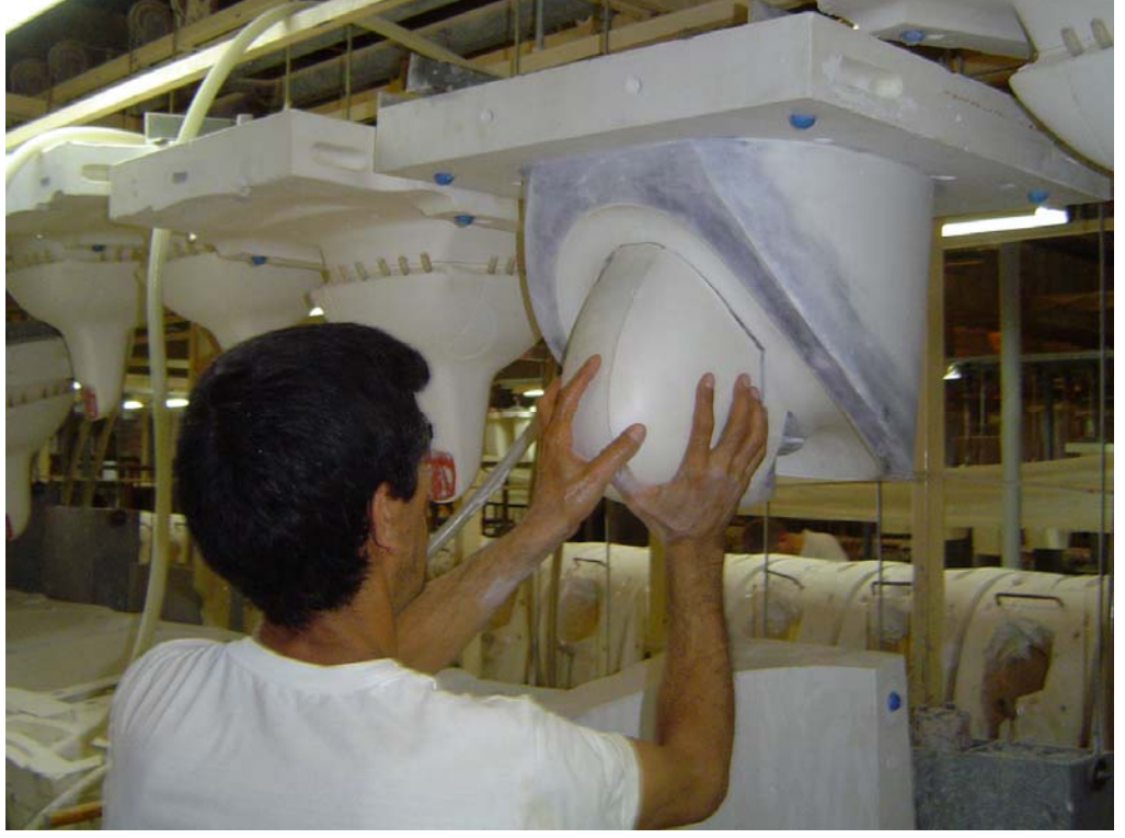
FOTOĞRAF 46: Üst parçaya mıknatıslı çekirdekler yerleştirilir.
