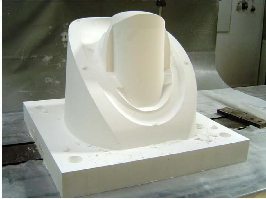
FOTOĞRAF 22: Kalıp üst parçasının işlenmiş görünümü
