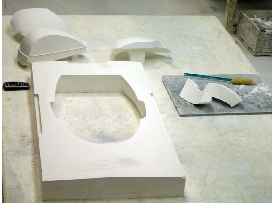
FOTOĞRAF 28: Mal alma kasnağı ve çekirdeklerin rötüşlanmamış görünümü
