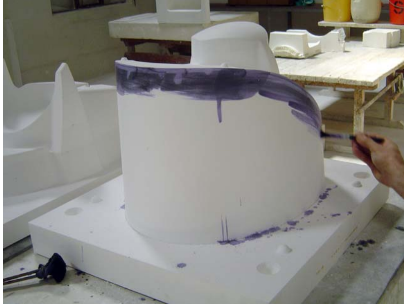
FOTOĞRAF 34: Kalıbın üst parçasının yan parçalara alıştırması esnasında kontrol için eritilmiş sabit kalem kullanıldı.
