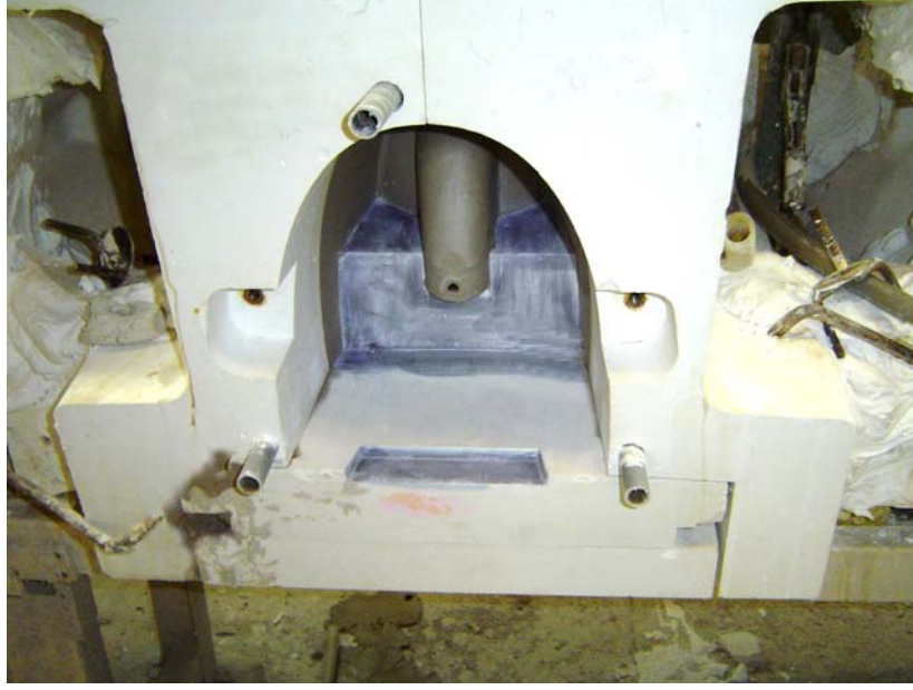
FOTOĞRAF 49: Alt parça kalıptan çıkarılır.
