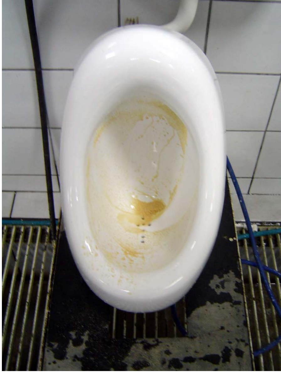
FOTOĞRAF 63: Pişirim sonrasında talaş ile fonksiyon testi
