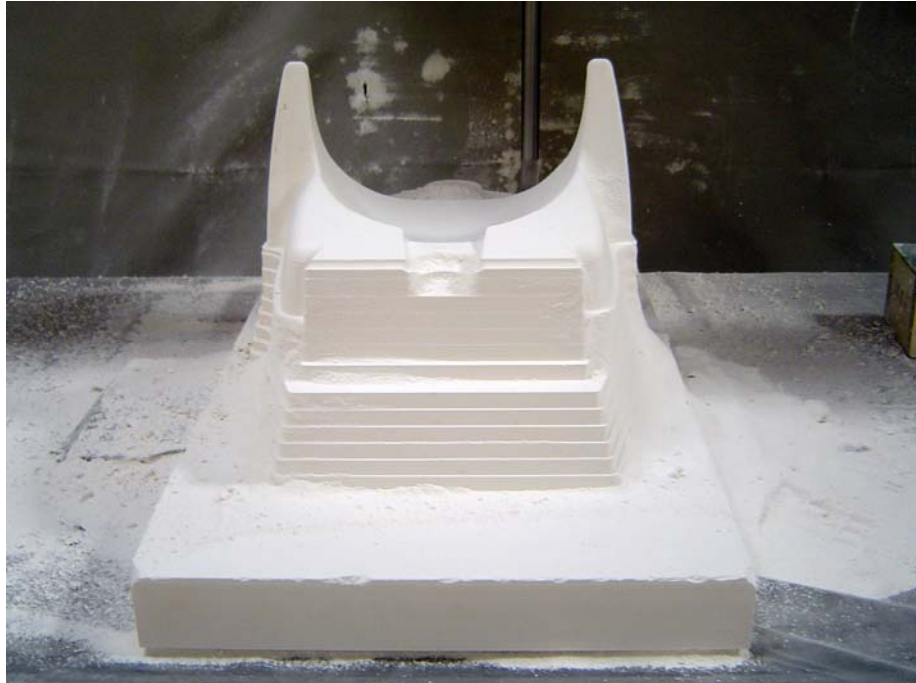
FOTOĞRAF 24: Kalıp arka parçasının işlenişi
