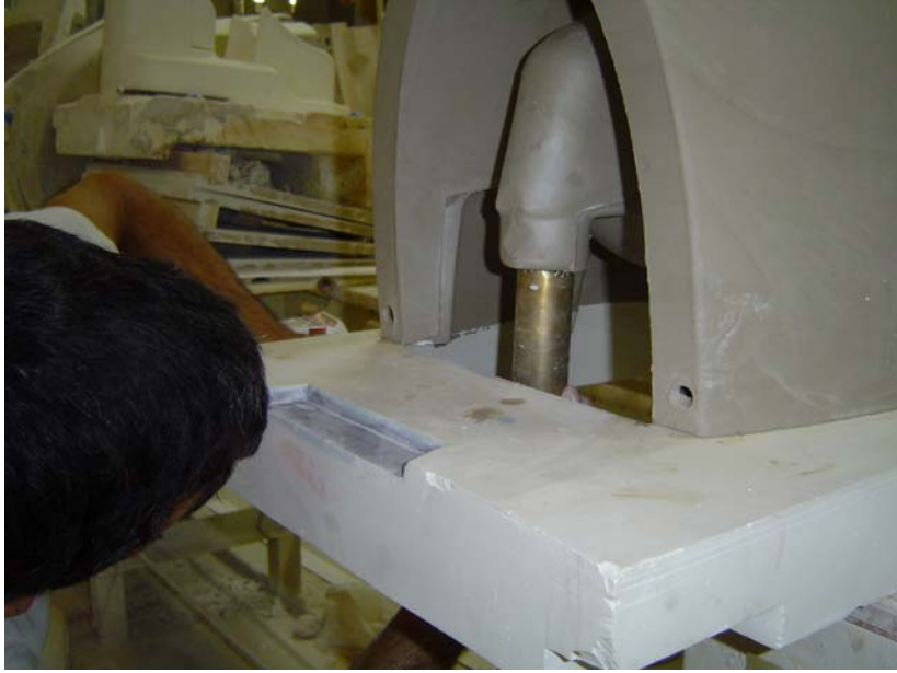
FOTOĞRAF 50: Döküm sonrası pis su giderinin pirinç bir boru yardımıyla kesilmesi
