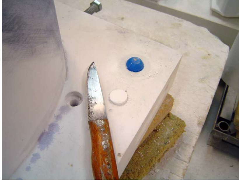
FOTOĞRAF 35: Kalıp parçalarının sahte pimleri kesilerek gerçek yuva ve pimler takılır
