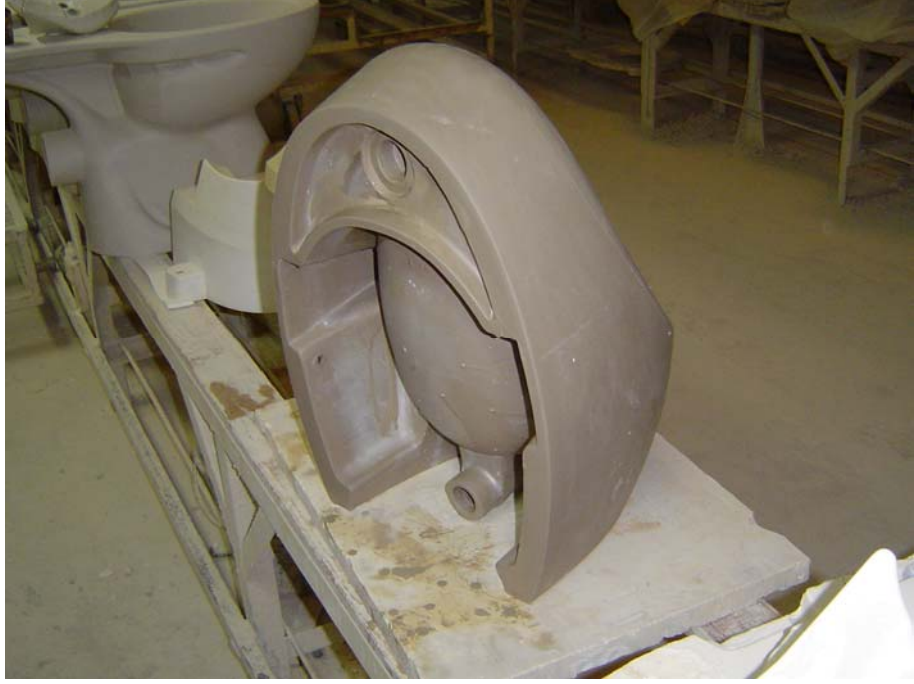
FOTOĞRAF 53: Ürünün kalıptan ayrılmış görünümü
