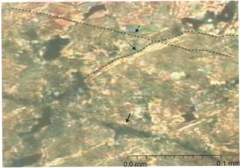
Şekil 16 GM2 Kalsit Kristali Üç Eksenli (Yanal Basınç: 0.5 MPa) Deney Sonrası Dikey Kesit Mikroskop Görüntüsü (1250 Büyültme)
