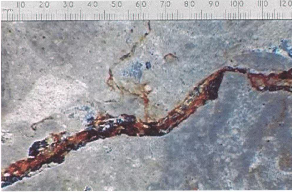
Şekil 3. 48 KÇT3 Zamana Bağlı Deformasyon (23000 kgf) Sonrası Dikey Kesit Mikroskop Görüntüsü (400 Büyültme)
