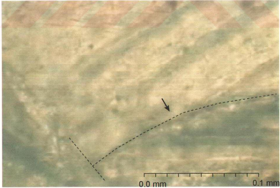
Şekil 2. 12 GM1 Kalsit Kristali Deformasyon Sonrası Dikey Kesit Mikroskop Görüntüsü (1250 Büyültme)
