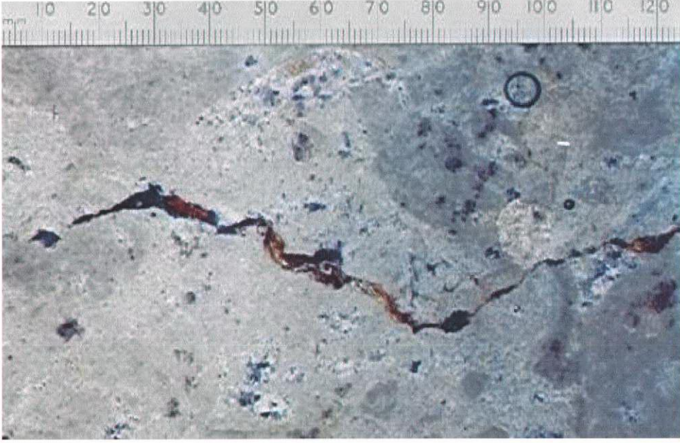
Şekil 55 KÇT3 Üç Eksenli (Yanal Basıncı: 0.5 MPa) Deney Sonrası Yatay Kesit Mikroskop Görüntüsü (400 Büyültme)
