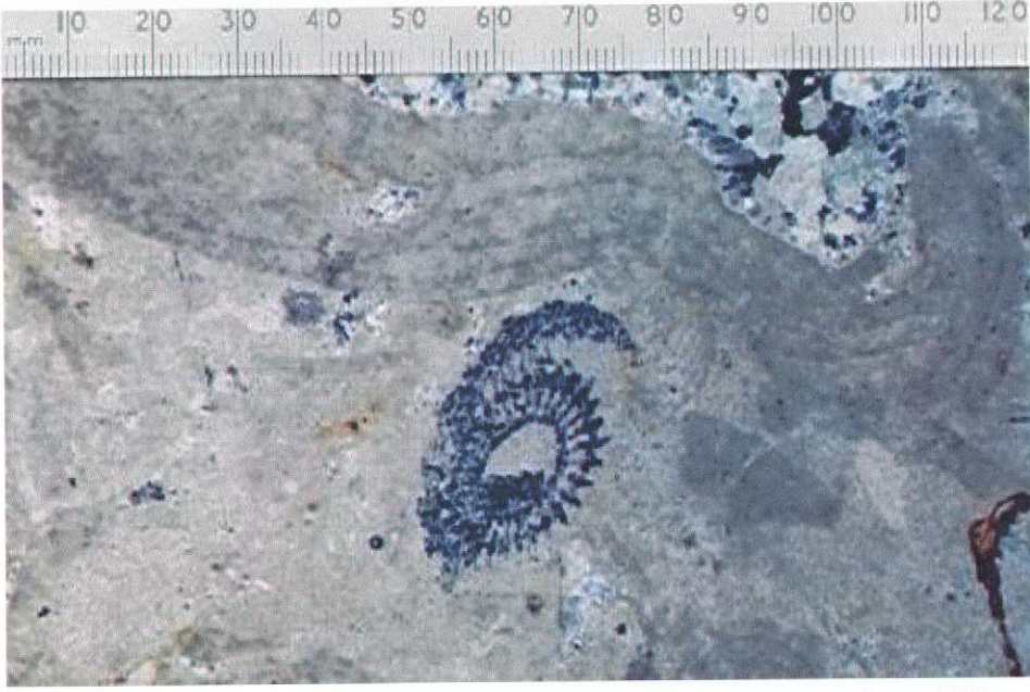
Şekil 57 KÇT3 Üç Eksenli (Yanal Basınç: 1.0 MPa) Deney Sonrası Yatay Kesit Mikroskop Görüntüsü (400 Büyültme)
