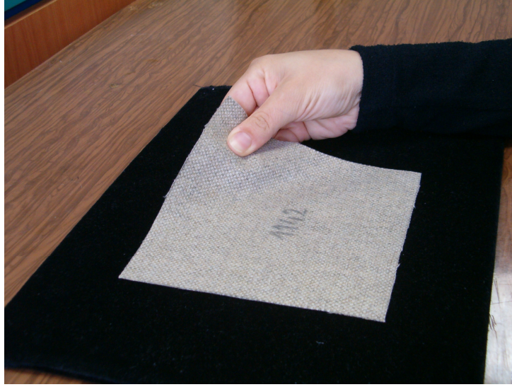
Şekil 2.2.b İncelik-kalınlık özelliği için subjektif değerlendirme tekniği (orig.)
