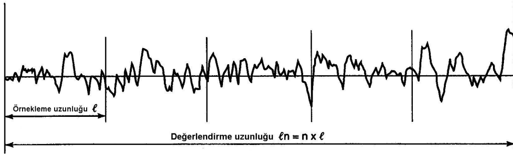
Şekil 3.4 R_a 'nın grafik üzerinde gösterimi (Mitutoyo SJ 301 Yüzey Pürüzlülük Ölçeri Kullanıcı Kılavuzu)
