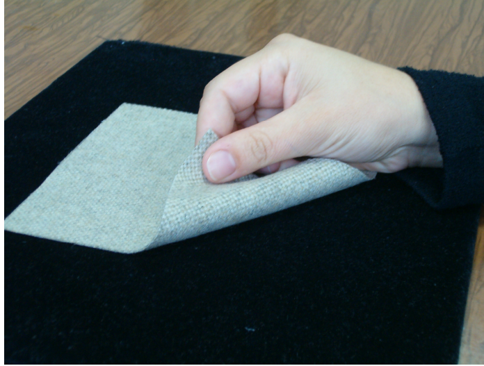
Şekil 1.b Yumuşaklık-sertlik özelliği için subjektif değerlendirme tekniği
