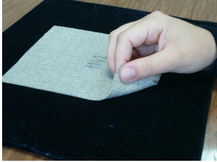
Şekil 2.3.a Yumuşaklık-sertlik özelliği için kumaşın ele alınması (orig.)
