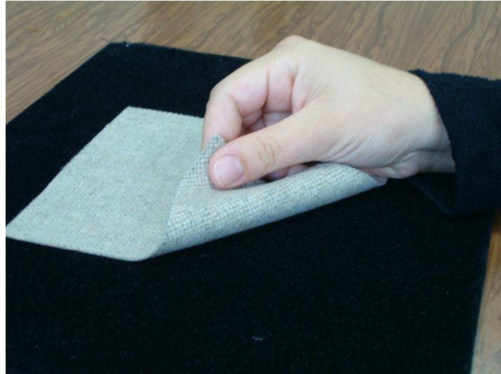
Şekil 2.3.a Yumuşaklık-sertlik özelliği için kumaşın ele alınması (orig.)
