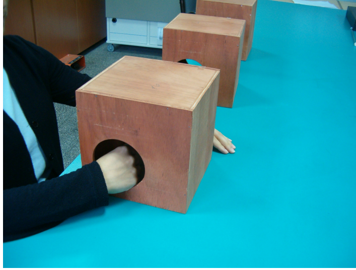
Şekil 2.5 Jüri üyesinin standart kutular içerisindeki kumaşları değerlendirmesi (orig.)
