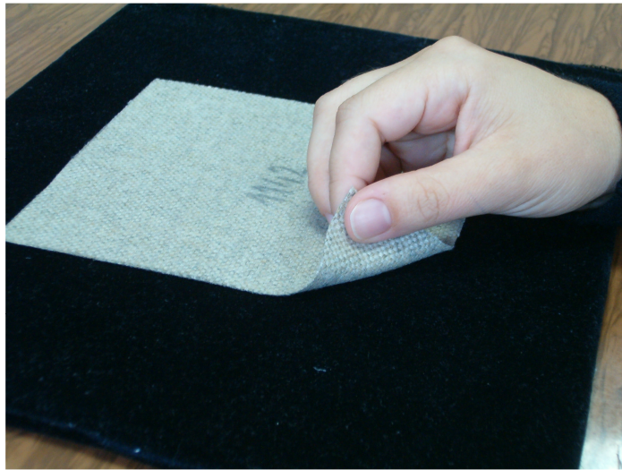
Şekil 1.a Yumuşaklık-sertlik özelliği için kumaşın ele alınması (orig.)
