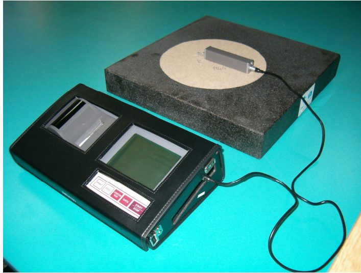
Şekil 2.6 Mitutoyo SJ 301 yüzey pürüzlülük ölçeri ile granit levha üzerinde ölçüm (orig.)
