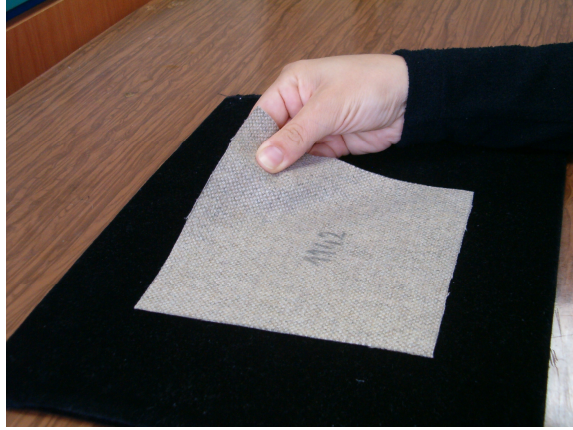
Şekil 1.b İncelik-kalınlık özelliği için subjektif değerlendirme tekniği (orig.)
