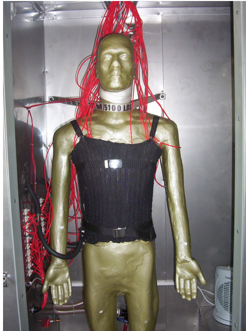
Şekil 6.11 Termal Manken ve Tasarlanan Giysinin Manken Üzerine Yerleşimi
