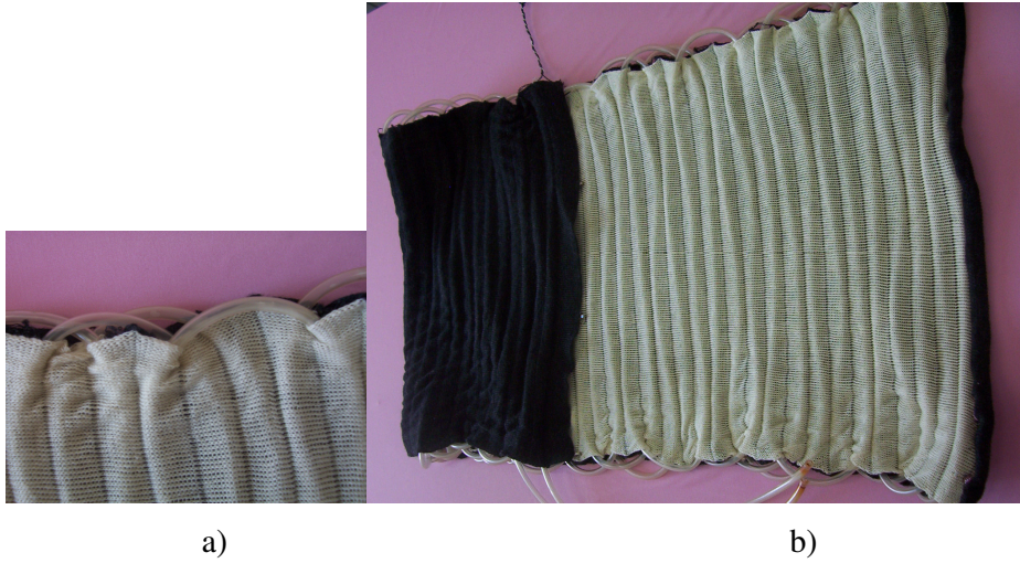
Şekil 6.6 Spacer SSG a) iç yüzeyinin yakından görünüşü b) dış ve iç yüzeyinin genel görünümü
