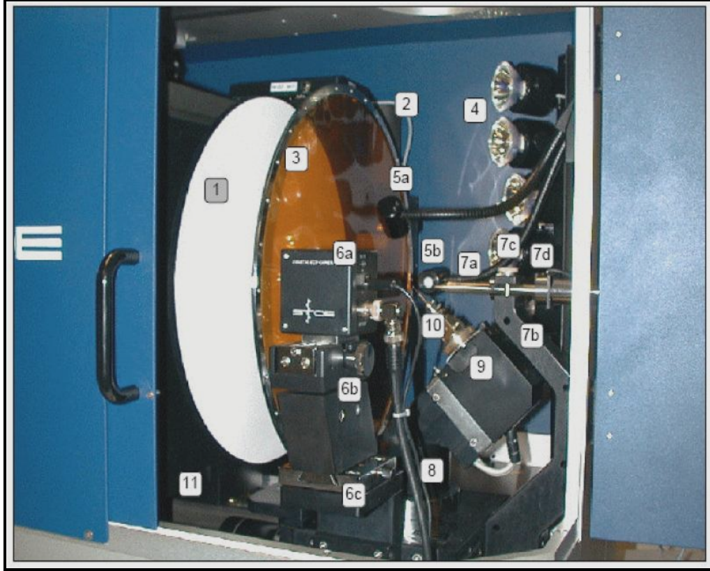
Şekil 2.3 IPDS II cihazının iç kısmının ayrıntıları. (1) Görüntüleme plakası-GP (2) Okuyucu kafa (3) Ana ışın tutucusu (4) Silici ışıklar (5a) ve (5b) Örnek aydınlatma lambaları (6) Video kamera (6a) Kamerayı hareket ettiren tutucu (6b) Optik kısım (7a) Eksenleştirici (7b) Eksenleştirici tutucusu (7c) Ek sabitleme vidası (7d) Güvenlik düğmesi (8) Omega dönü eksen (9) Phi eksen-örneği döndüren eğik eksen (10) Gonyometre başlığı (11) Görüntüleme plakası taşıyıcısı.
