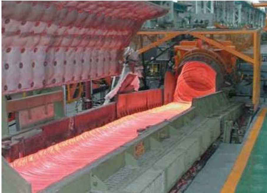
Resim 15.2 Sıcak telin kangal şeklinde serilmesi.
