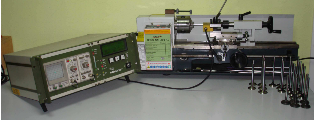
Şekil 11.3 Yüzeysel çatlak kontrol deney düzeneği.
