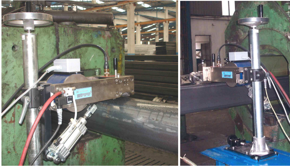
Şekil 12.8 (a) Segment bobinle boru kontrolü, (b) Segment bobinle profil kontrolü.
