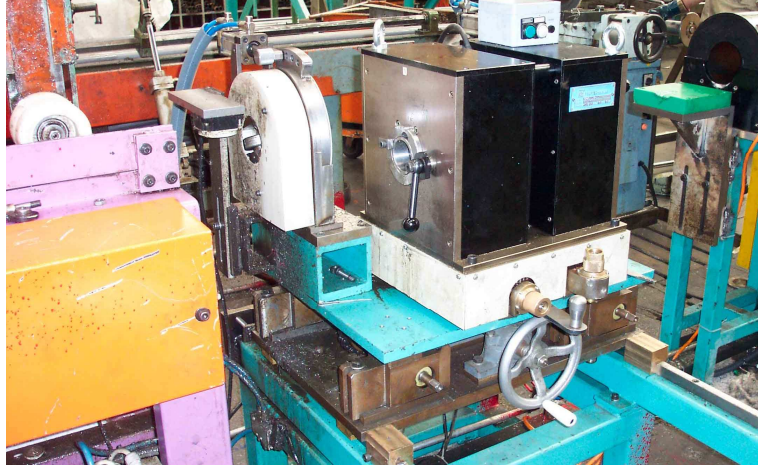
Şekil 12.10 Offline dairesel bobin test sistemi.
