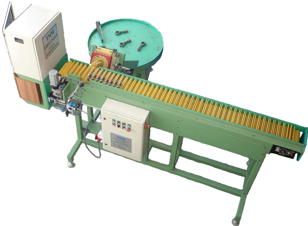
Şekil 10.6 Girdap akımı ile otomatik malzeme test ve ayırım sistemi.
