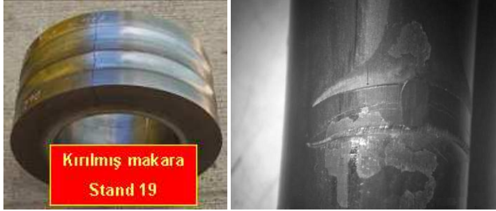
Şekil 15.8 Kırılan makara ve malzeme üzerinde oluşturduğu etki (yüzey deformasyonu).
