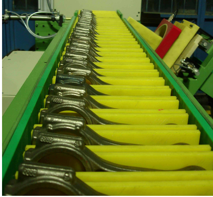
Şekil 10.10 Otomatik girdap akımı malzeme test-ayırma sistemi.
