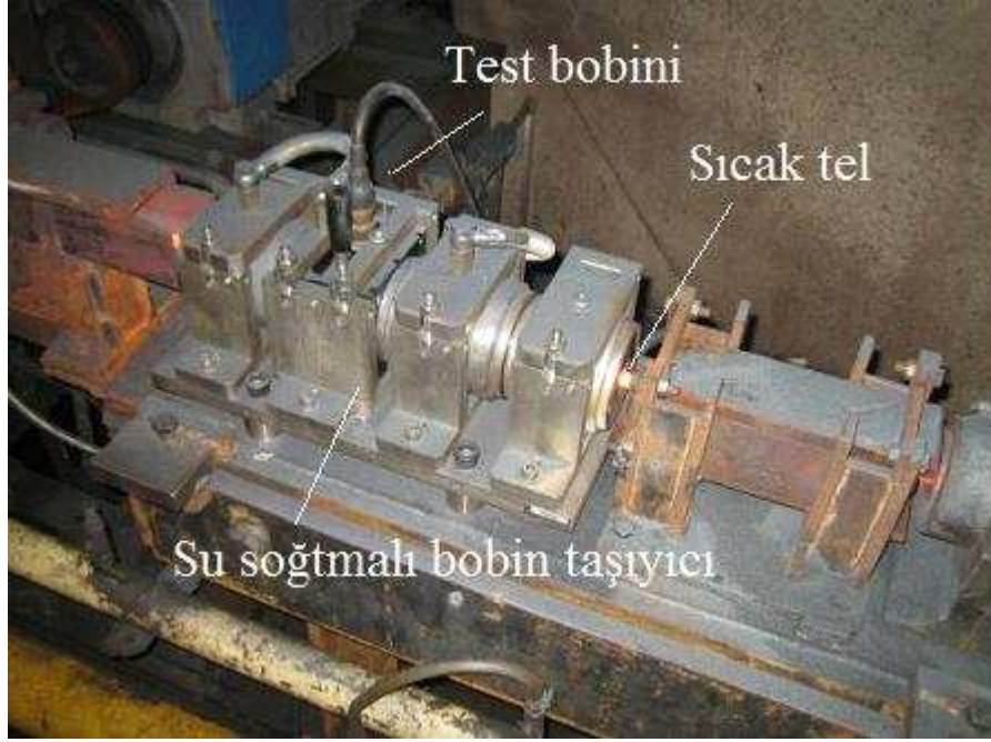
15.3 Girdap akımları ile sıcak tel ve mil kontrolü.
