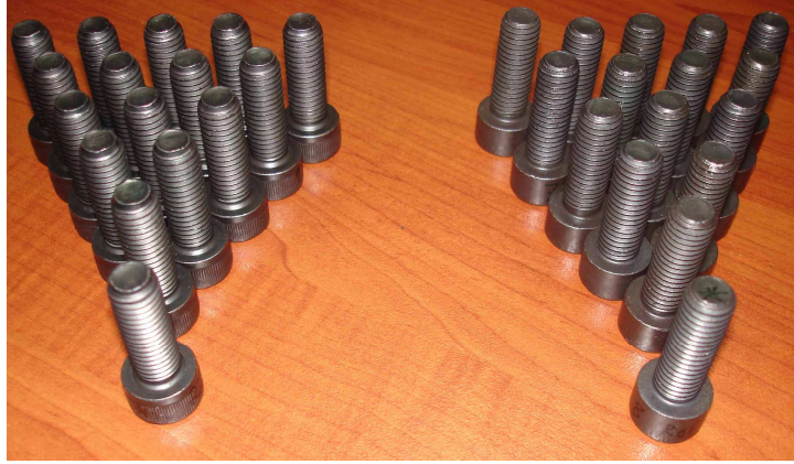
Şekil 10.1 8.8 ve 12.9 kalite M10x30 gömme başlı civatalar.
