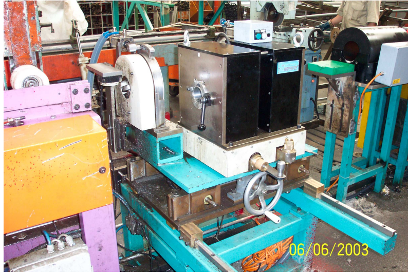
Şekil 12.29 Offline boru kontrol sistemi.
