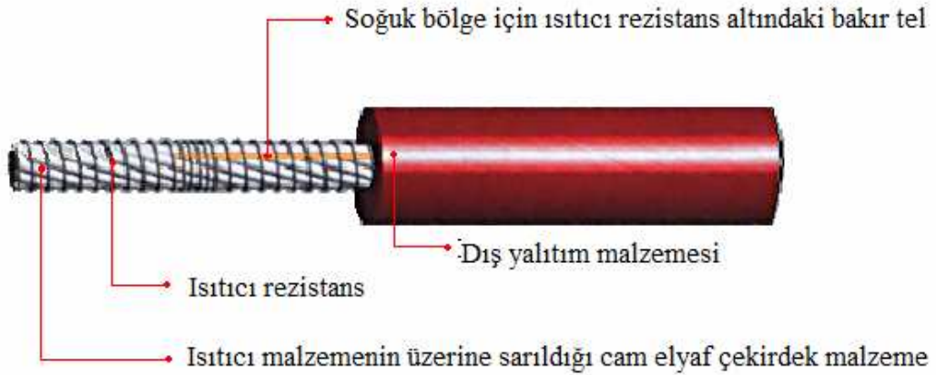
Şekil 16.1 Defrost kablosunun genel özellikleri.
