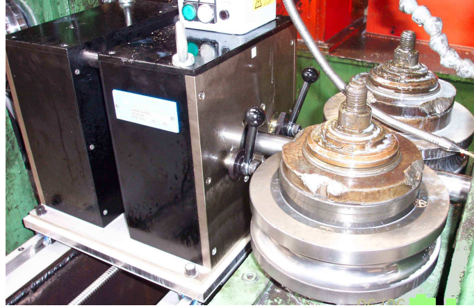
Şekil 12.7 Girdap akımları ile online boru kontrolü.
