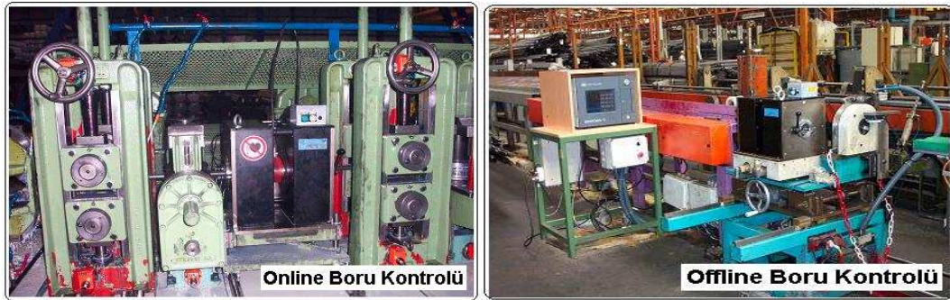
Şekil 12.6 a) Online ve b) Offline boru kontrollerinde örnek uygulamalar.
