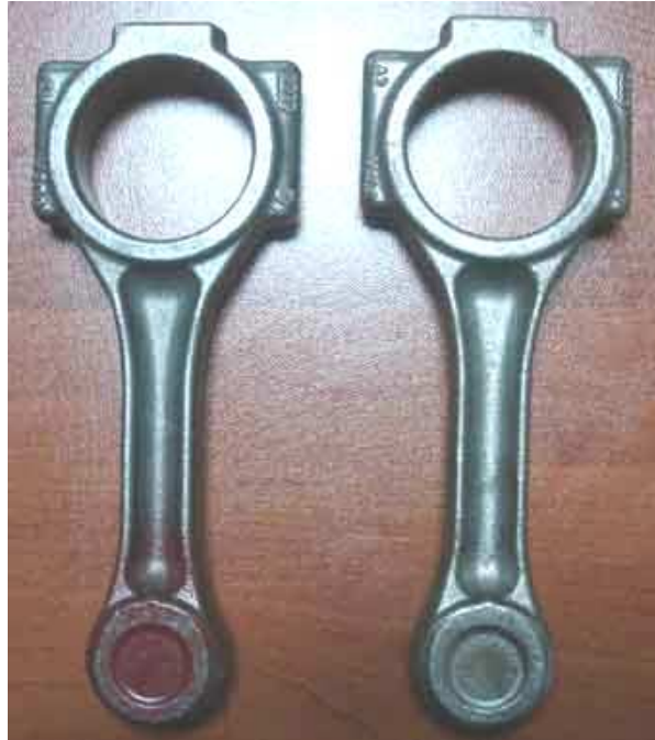
Şekil 10.11 (a)Uygun (b) Uygun olmayan biyel kolları.
