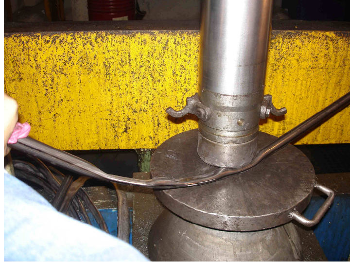
Şekil 12.3 Yassılma testi ile kaynak dikişinin tahribatlı muayenesi.
