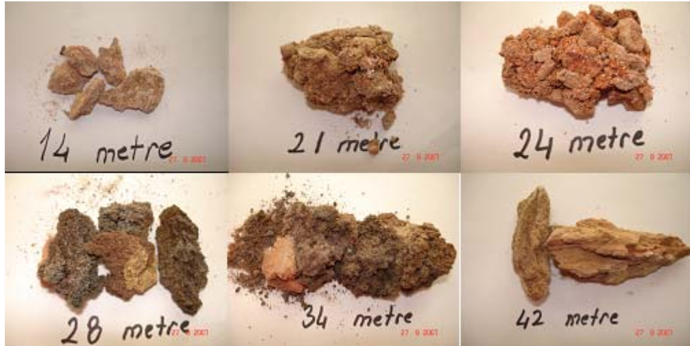
Şekil 4.83 Yeniköy termik santrali kazan içi curuf numuneleri
