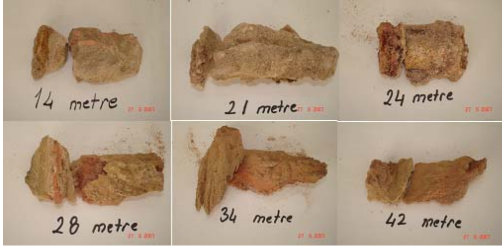
Şekil 4.82 Kemerköy termik santrali kazan içi curuf numuneleri
