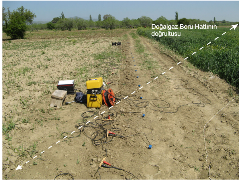
Şekil 6.36 Doğalgaz boru hattı üzerinde alınan profil
