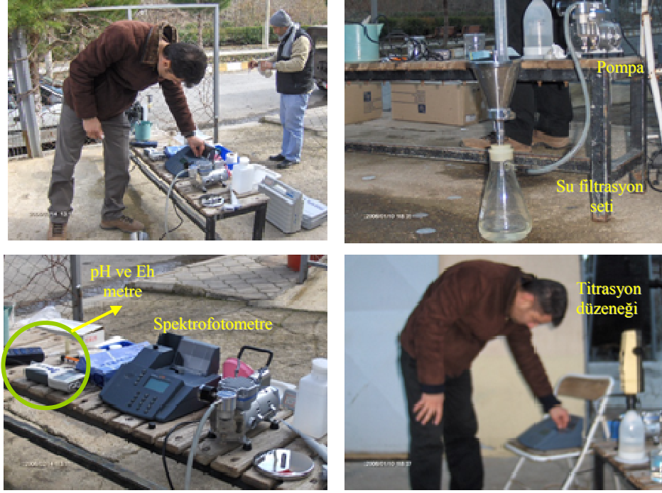
Şekil 2.1 Arazi çalışmasında kullanılan örnekleme ve ölçüm ekipmanları.
