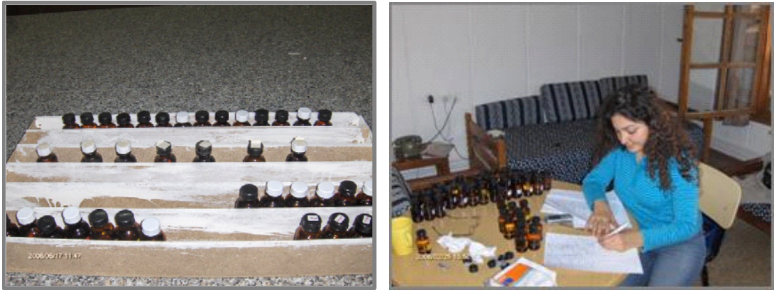
Şekil 8.6 İzleyici deneyi örnekleme yöntemi.
