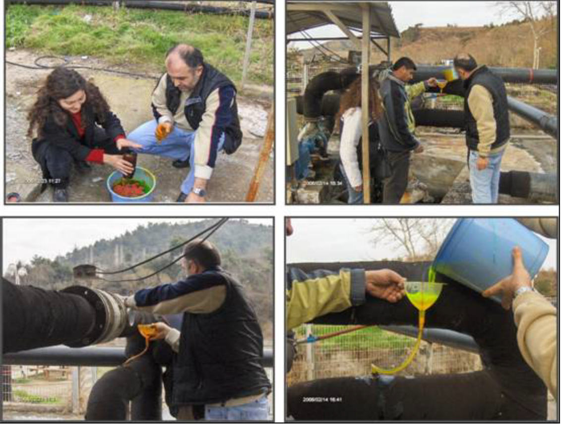
Şekil 8.5 Flüoreseinin re-enjeksiyon kuyularına karıştırılması.
