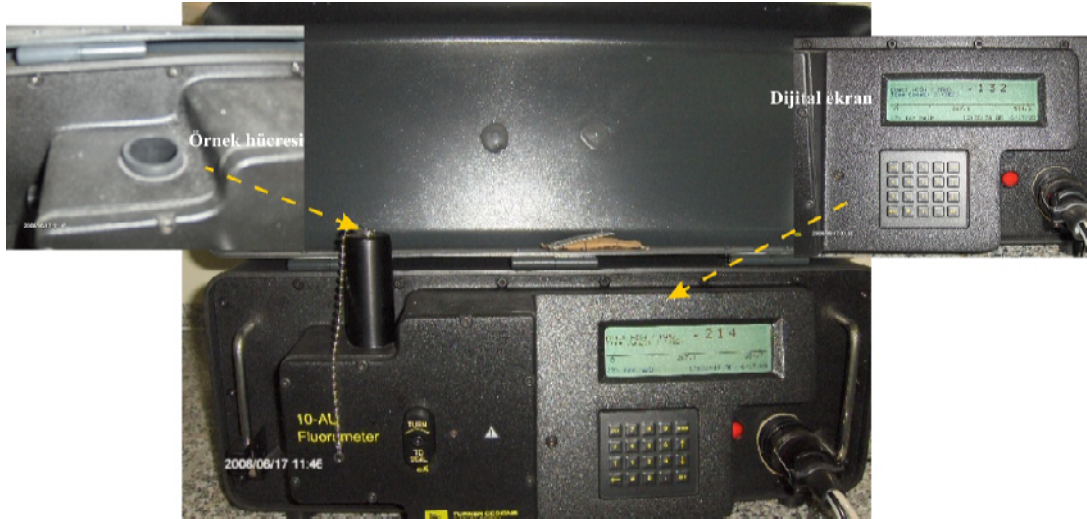
Şekil 8.4 Turner 10AU-005-CE model dijital fluorometre cihazı.
