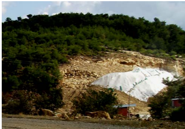
Şekil 4.4 Zeolit madenciliğinde kazılmış ürünün açık ocakta branda ile muhafazası
