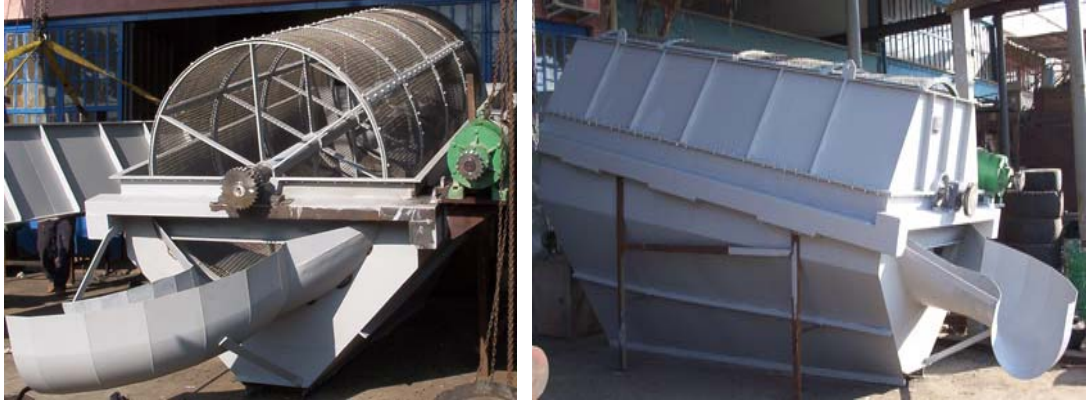
Şekil 4.5 Zeolit mineralinin elenmesinde kullanılan bir döner (silindirik) elek
