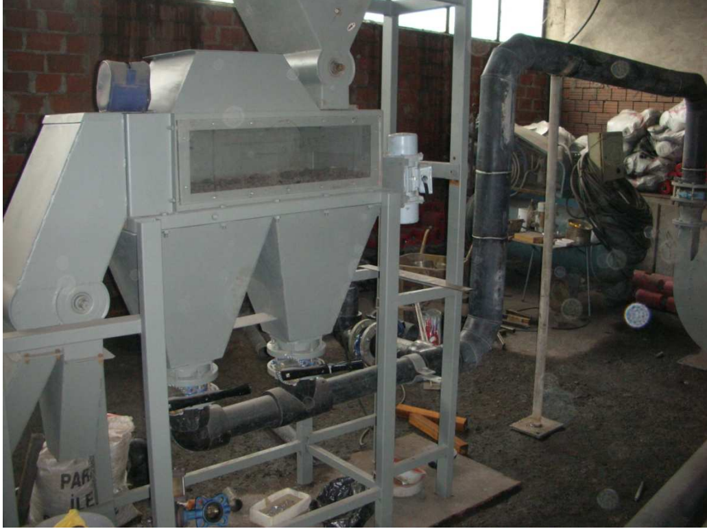
Şekil 3.6 Pilot çapta imalatı yapılan tesisin görüntüsü.
