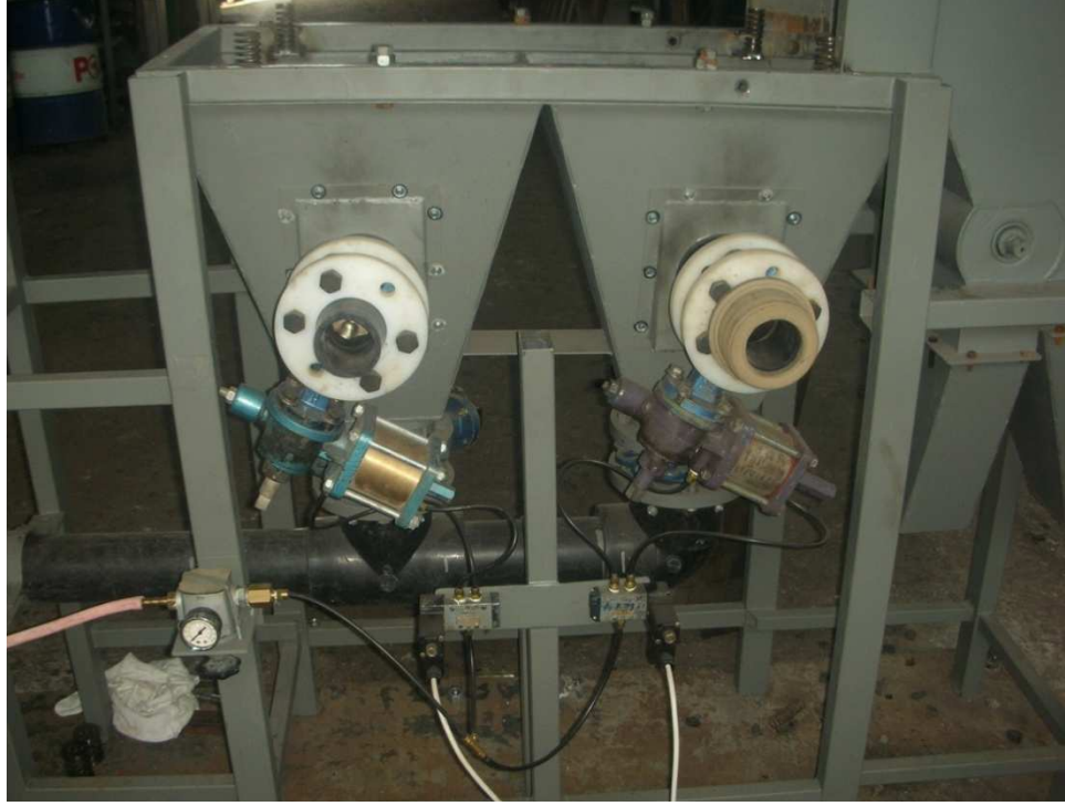
Şekil 3.5 Eleğe alttan verilen pulsasyonlu hava sisteminin görüntüsü.
