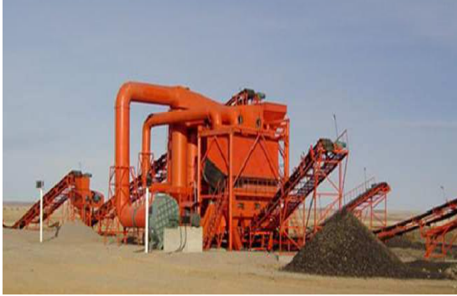
Şekil 2.11 Güney Afrika'da kurulmuş olan FGX-12 kuru zenginleştirme tesisinin görüntüsü (Korte, 17 Temmuz 2009).
