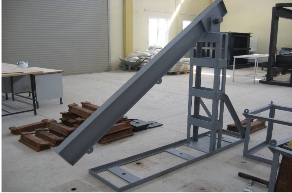
Şekil 5.21 Uzun süreli aksel çekme numune deneyleri için geliştirilmiş yükleme sistemi.
