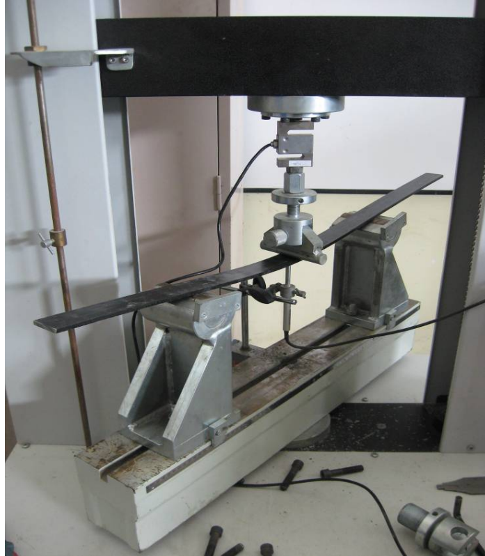
Şekil 5.11 Üç nokta eğilme deney sistemi ve CTP numunesi.
