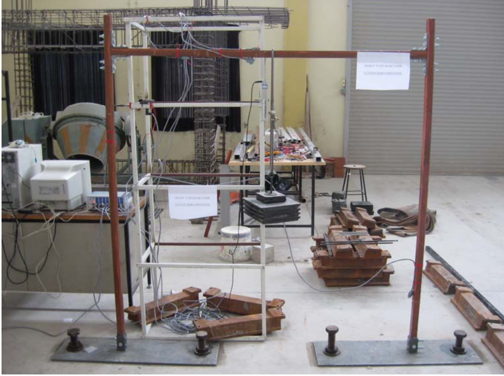
Şekil 5.39 Viskoelastik davranışı incelenen tek katlı ve tek açıklıklı çerçeve sistem.
