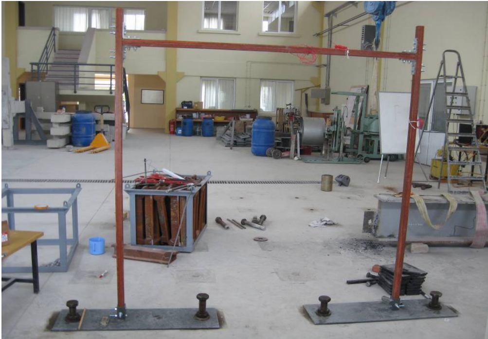
Şekil 5.36 Tek katlı ve tek açıklıklı CTP kutu kesitli düzlem çerçeve.
