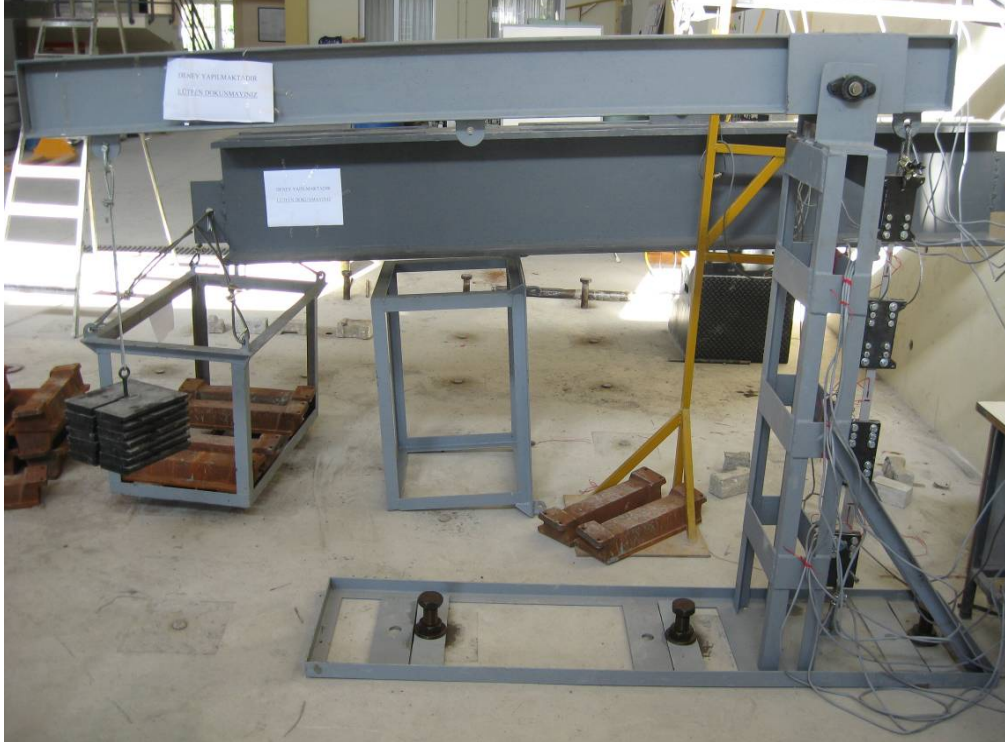
Şekil 5.27 Yükleme sistemi ve incelenen üç deney numunesi.
