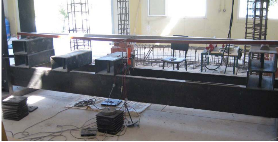
Şekil 5.32 Tek açıklıklı CTP kutu kesitli kiriş.
