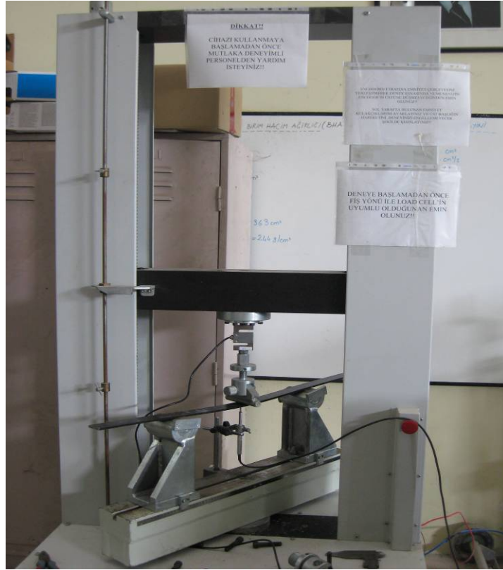
Şekil 5.10 Üç nokta eğilme deneyi sistemi.
