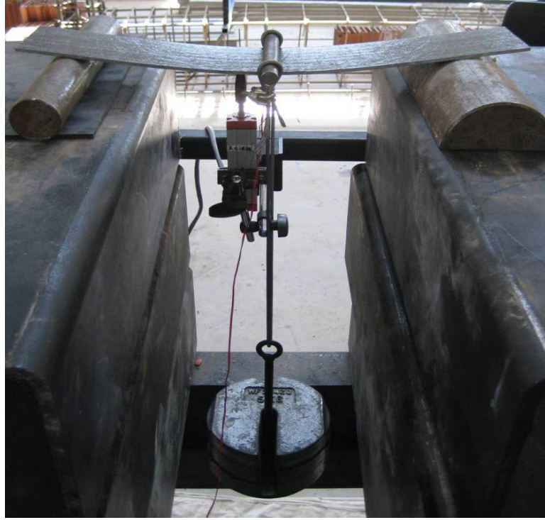
Şekil 5.15 Kısa süre ile zamana bağlı üç nokta eğilme deneyi numunesi.
