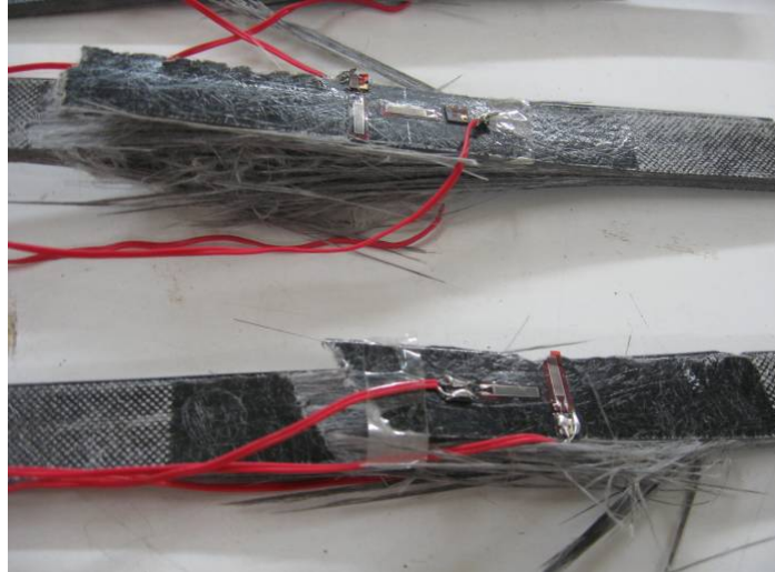
Őekil 5.9 Deney sonrası CTP numuneler ve cam elyaflar.
