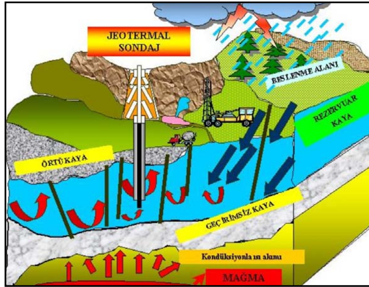
Şekil 4.1 Jeotermal sistemin oluşum modeli
