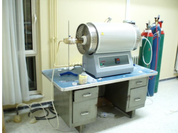
Şekil 7.5 Protherm marka tüp fırın ve sinterleme düzeneği
