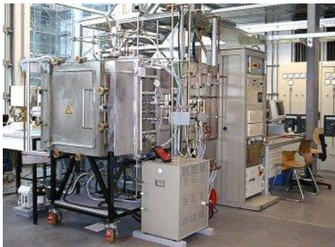
Şekil 7.6 Mikrodalga fırını ve sinterleme düzeneğinin şematik gösterimi
