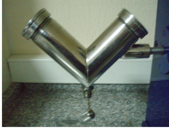
Şekil 7.3 Deneysel çalışmalarda kullanılan V-tipi karıştırıcı
