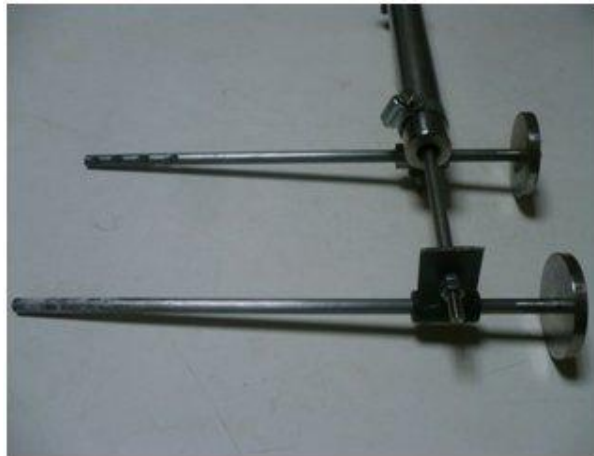
(c) Yerdeğiştirme ölçer uygulama düzeneği birleşim detayı
