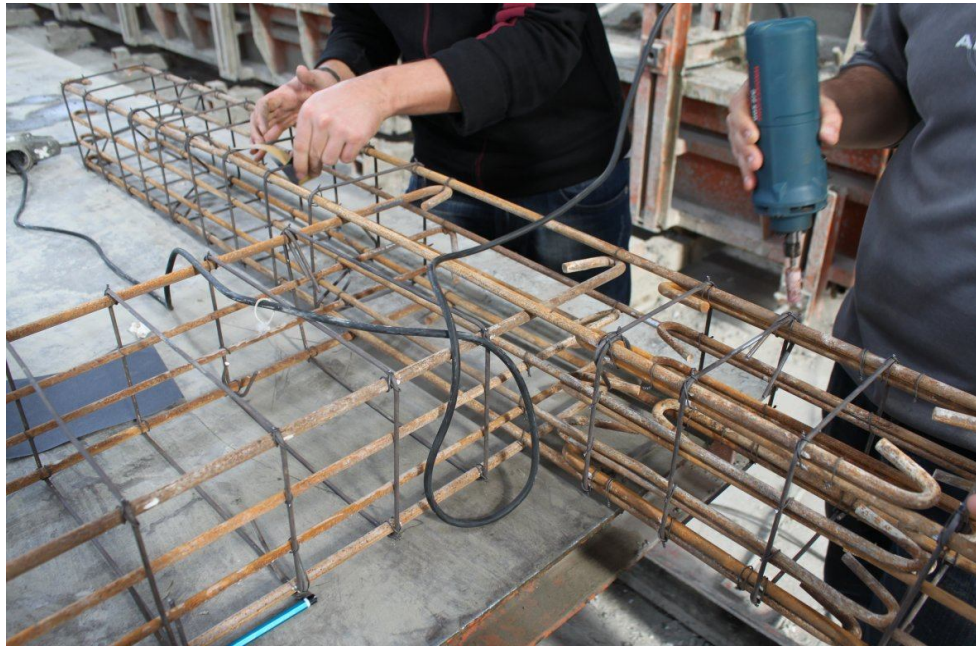
Şekil C.1 Gerinim ölçer yerleştirilecek bölgelerdeki yüzeyin taşlanarak temizlenmesi
