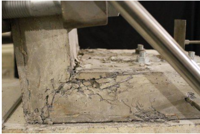
Şekil 2.32 S2 numunesinin % 9,0 ötelenmedeki hasar durumu.
