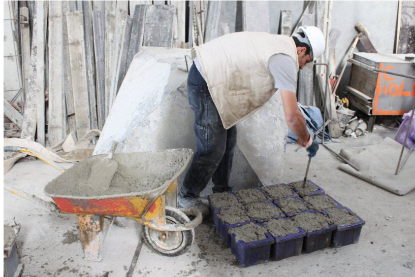
Şekil C.7 Her numune için alınan altışar adet 15'lik küp beton numuneleri
