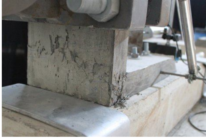
Şekil 2.36 S3 numunesinin % 7,4 ötelenmedeki hasar durumu.
