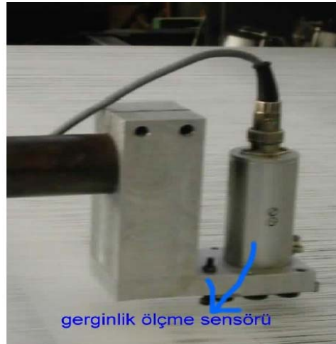
Şekil 2.6 Dokuma makinasında kullanılan gerginlik ölçme sensörü (Özkan, 2005)
