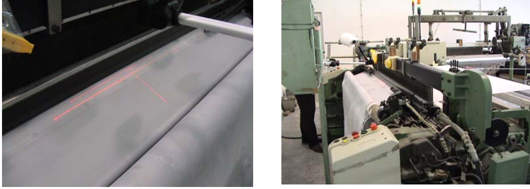
Şekil 2.29 Görüntü alma sistemi ve lazer konumları
