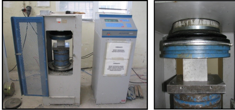
Şekil 8.29 Üretilen deneme betonlarına basınç dayanımı deneyinin uygulaması
