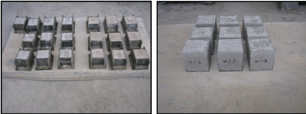
Şekil 8.27 Beton üretiminde kullanılan 15x15x15 cm’lik kalıplar ve 24 saat sonra kalıptan çıkarılmış küp örnekler.
