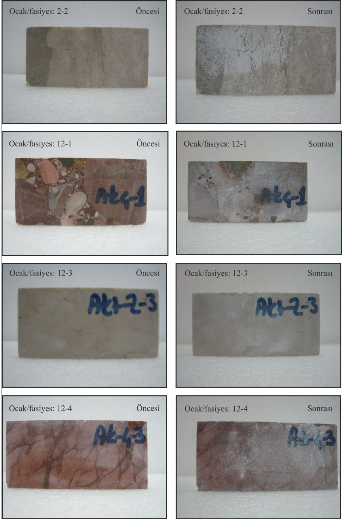
Şekil 7.29 Kireçtaşlarının nemli ortamda SO 2 buharında maruz kaldığında görümlerindeki değişiklikler. Ölçek. Uzun kenar 12 cm (derisik A çözeltisi).
