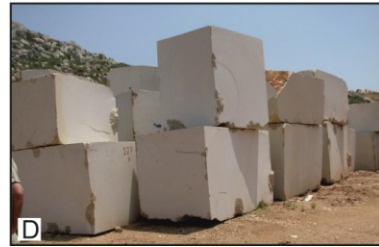
Şekil 9.7 Karahasan Kireçtaşı Üyesi (12 numaralı ocak) içerisinde açılmış blok taş ocağı (A), litik çakıltaşı fasiyesinden üretilen bloklar (B) ve litik çakıltaşının fayans görüntüsü (C), bej renkli istifası-tanetaşı fasiyesinden üretilen bloklar (D), bej renkli istifası-tanetaşı fasiyesinin fayans görüntüsü (E).
