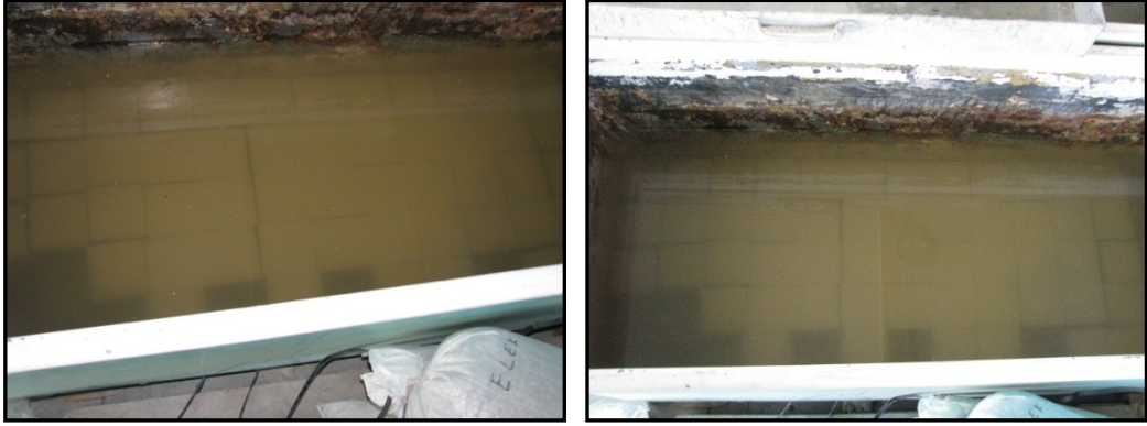
Şekil 8.28 Kirece doymun suda bekletilen beton örnekleri.
