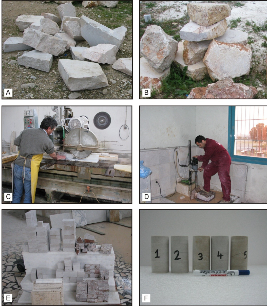
Şekil 7.1 Fiziko-mekanik özellikleri belirlemek için ocaklardan alınan blok numuneler (A, B), taş testersi (C), karot makinesi (D), deneyler için hazırlanmış numuneler (E, F)
