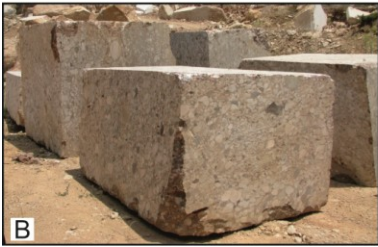
Şekil 9.7 Karahasan Kireçtaşı Üyesi (12 numaralı ocak) içerisinde açılmış blok taş ocağı (A), litik çakıltaşı fasiyesinden üretilen bloklar (B) ve litik çakıltaşının fayans görüntüsü (C), bej renkli istifası-tanetaşı fasiyesinden üretilen bloklar (D), bej renkli istifası-tanetaşı fasiyesinin fayans görüntüsü (E).
