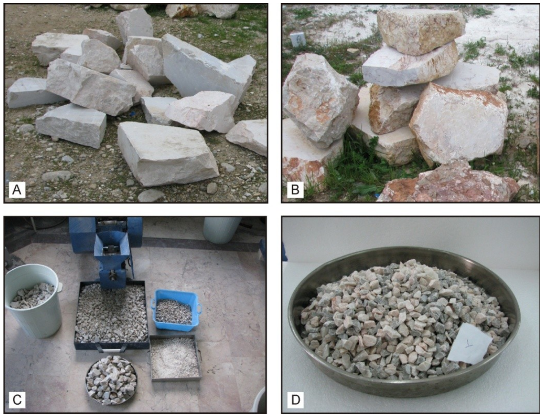
Şekil 8.2 Ocaklardan alınan blok numuneler (A, B), numunelerin çeneli kırıcıda kırılması (C), 10-14 mm çapında hazırlanmış agrega (D).
