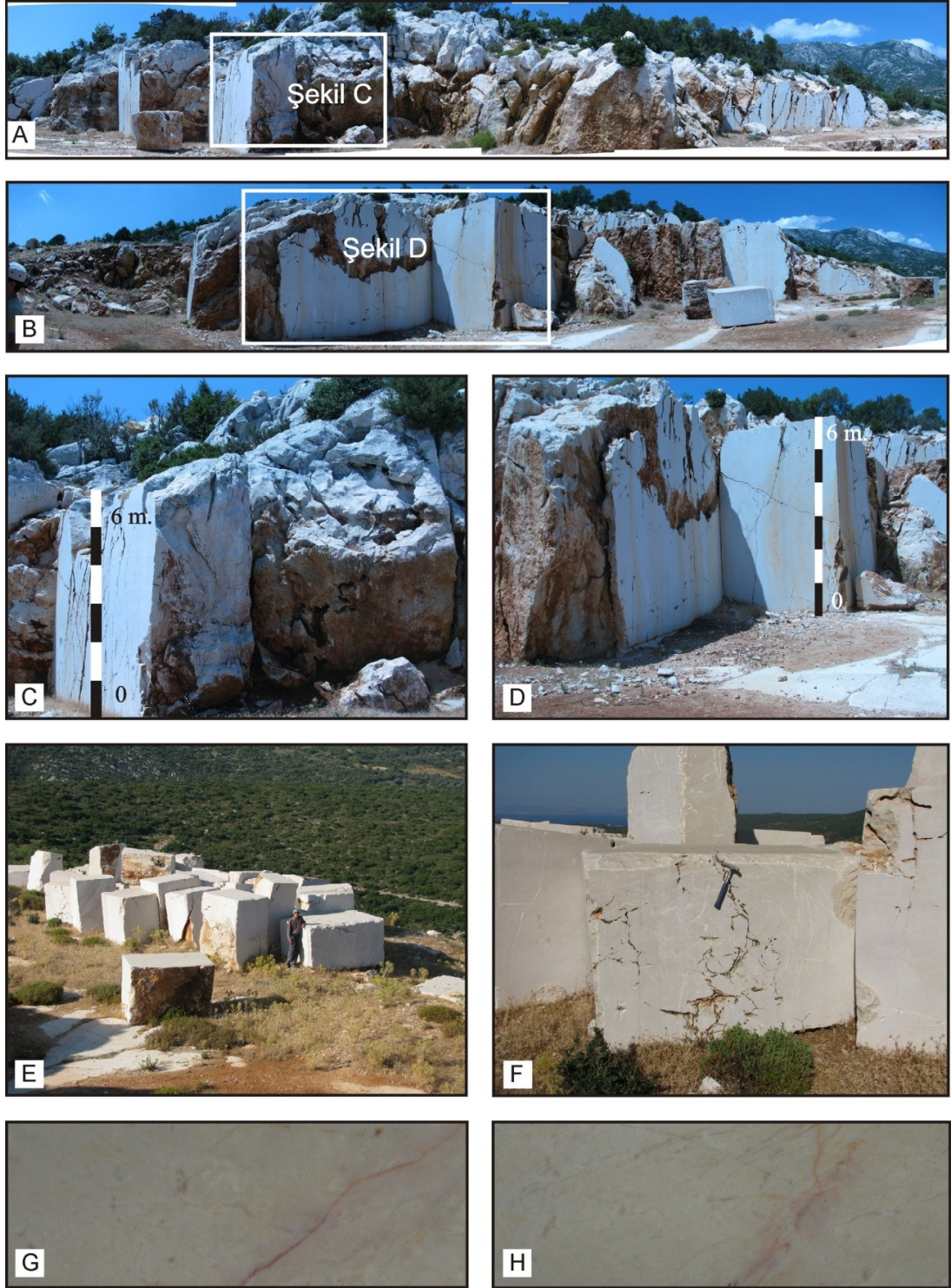
Şekil 4.68 Yedi numaralı blok taş ocağının görünümü (A, B,C, D), ocakta üretilen bloklar (E, F) ve 5x10 cm'lik fayansın görünümü (G, H). Koordinatlar: 35459795/4263854.
