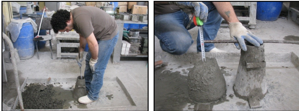
Şekil 8.23 Taze betonda çökme deneylei
