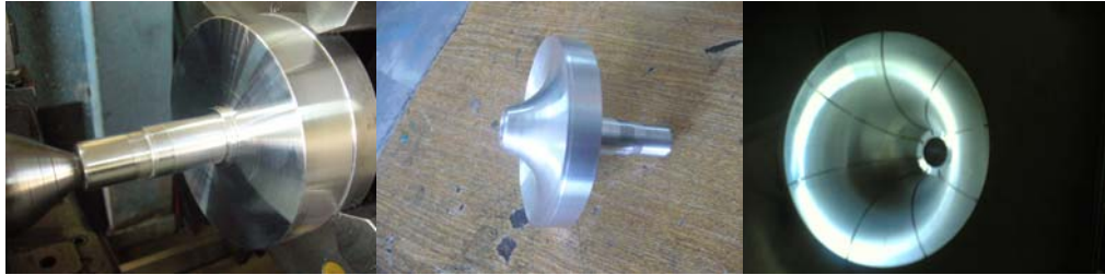
Şekil 4.30 7000 serisi (7075) alüminyum iğne silindiri.
