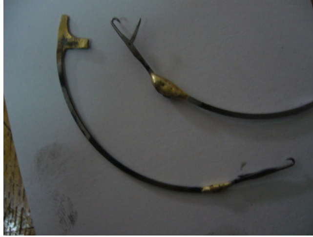
Şekil 4.42 Taşlandıktan sonra gümüş kaynağıyla uçları kaynatılan iğneler.
