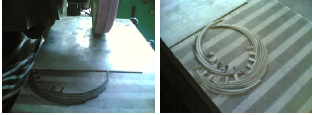
Şekil 4.40 Takım bileme aparatında taşlanarak nominal ölçülerine getirilen iğneler.
