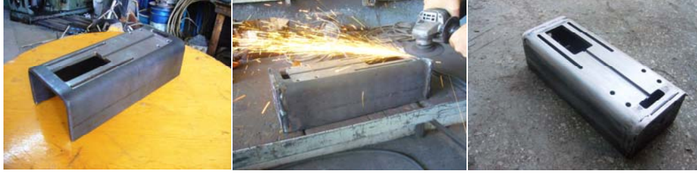
Şekil 4.32 Makine gövdesinin üretim aşamaları.
