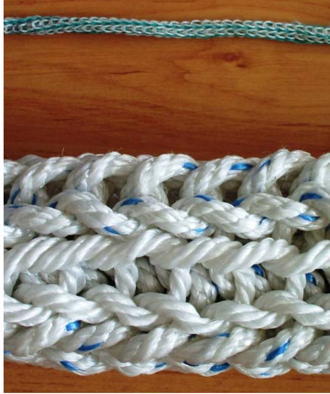
Şekil 3.11 Patente konu olan iki kordon yapısı (sadece ① ve ② iplik bileşenleri vardır)
