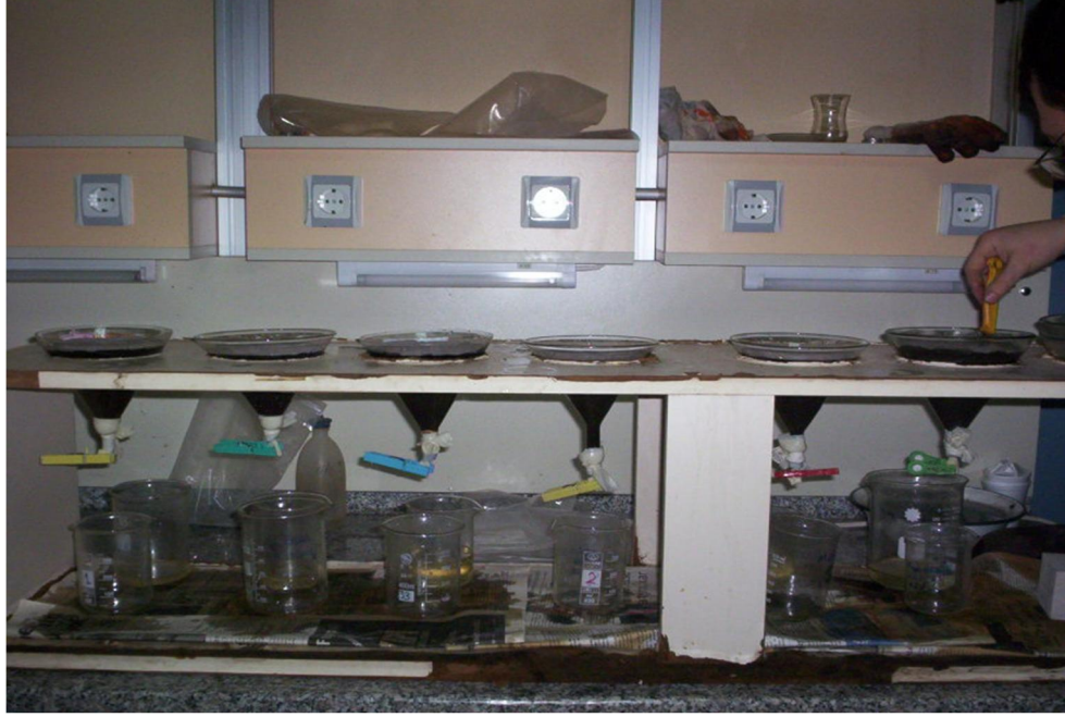
Şekil 3.28 0,355/0 mm tane aralığı yüzdürme-batırma testi yapılışı
