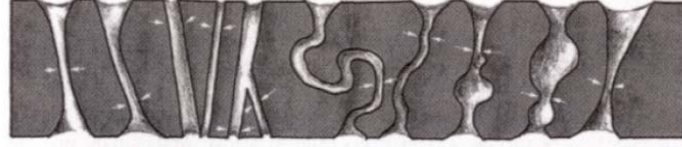
Şekil 1.26 Farklı gözenek çaplarına sahip gözenek boyunca yer alan en küçük çap (Jena ve Gupta, 2000,a)
