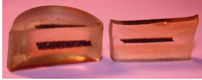
Şekil 3.3. Poliester reçine içine gömülmüş kumaş kalıp
