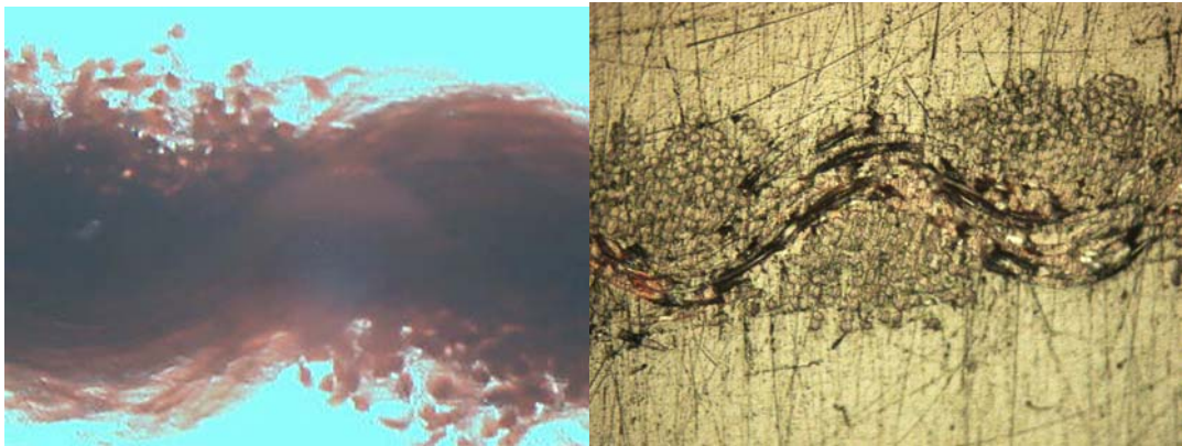
Şekil 3.4 a. Alttan aydınlatmalı mikroskoptan elde edilen poliester reçineli kumaş görüntüsü, b. Yansıtmalı mikroskopla elde edilen poliester reçineli kumaş görüntüsü (x10)
