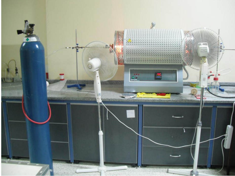
Şekil.5.5 Isıl işlemlerin yapıldığı 1600°C'lik fırın düzeneği
