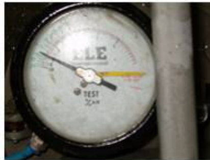
Şekil 9.11 Taze betonun hava ölçer ile hava içeriğinin tespit edilmesi
