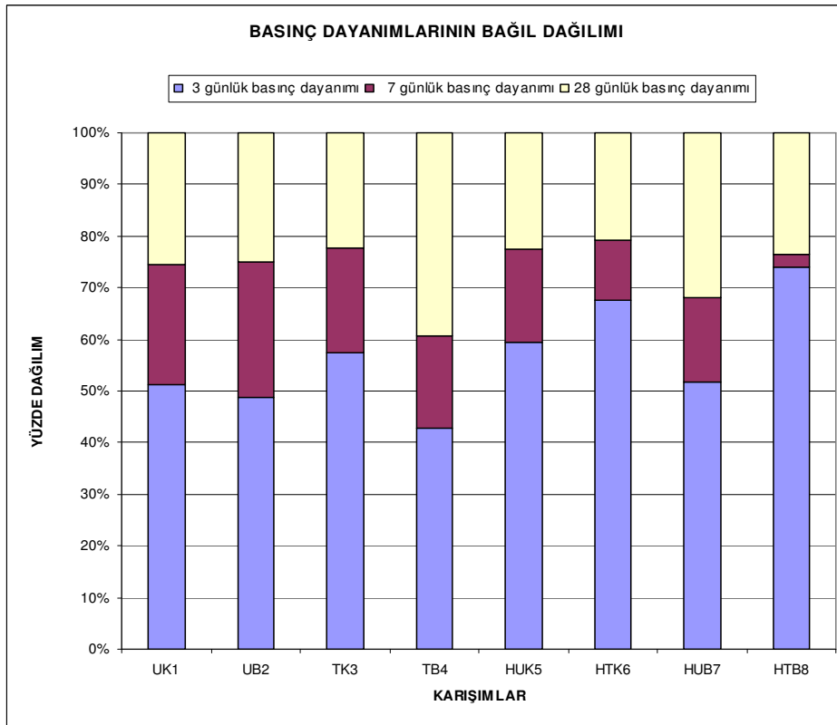
Şekil 9.27 Küp örneklerin 3, 7 ve 28. günlerdeki bağıl basınç dayanımları
