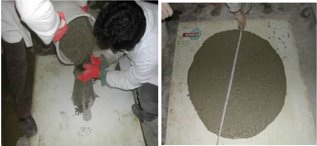
Şekil 9.8 Yayılma deneyinin yapılması ve yayılma çapının ölçülmesi
