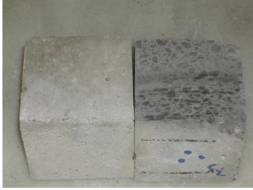
Şekil 9.25 Aşınmaya uğramış örneğin kontrol örneğiyle karşılaştırılması
