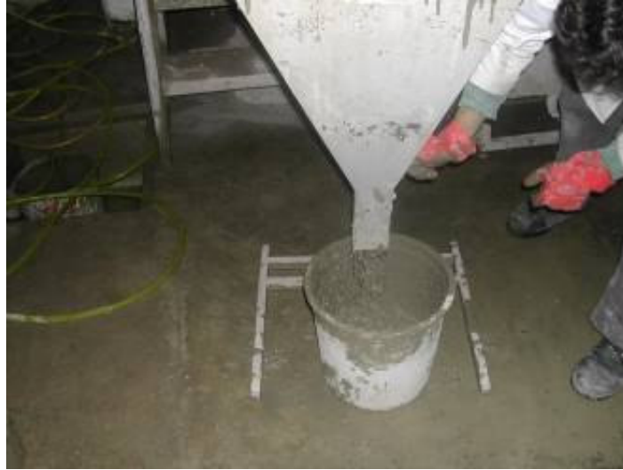
Şekil 9.10 V-hunisi deneyinin yapılışı
