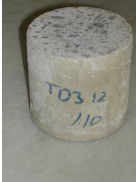
Şekil 9.17 Karot makinesiyle kesilerek elde edilen 10/10 silindir örneği
