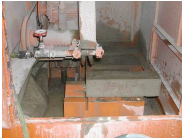
Şekil 9.14 Kiriş örneklerin ultrases deneyi için yüzeylerinin traşlanarak düzeltilmesi
