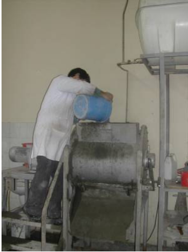
Şekil 9.7 Beton karışım malzemelerinin mikserde doldurulması
