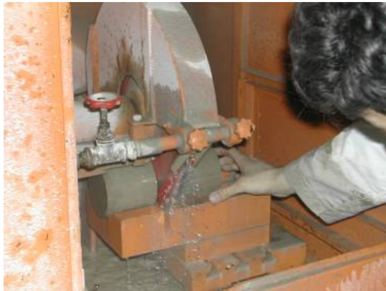
řekil 9.16 10/20 silindirlerin donma çözülme deneyi için ortadan ikiye kesilmesi
