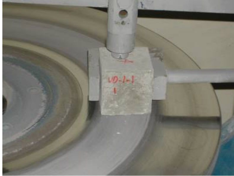
Şekil 9.22 Örneğe aşınma deneyinin yapılması
