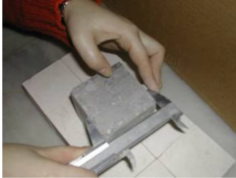
Şekil 9.24 Örnek kenar boyutlarının ölçümlerinin yapılması
