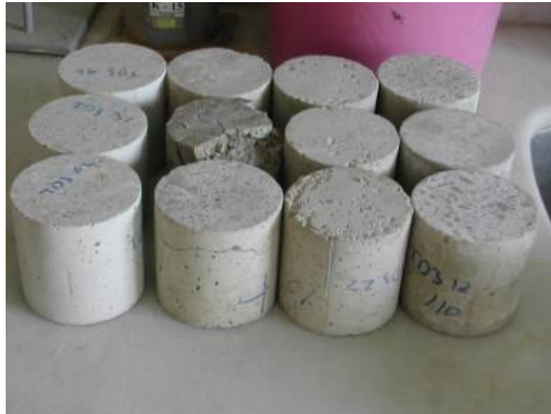
řekil 9.21 Donma-özölme sonunda tuz konsantrasyonlarına göre örneklerin fiziksel durumlarının gözlenmesi
