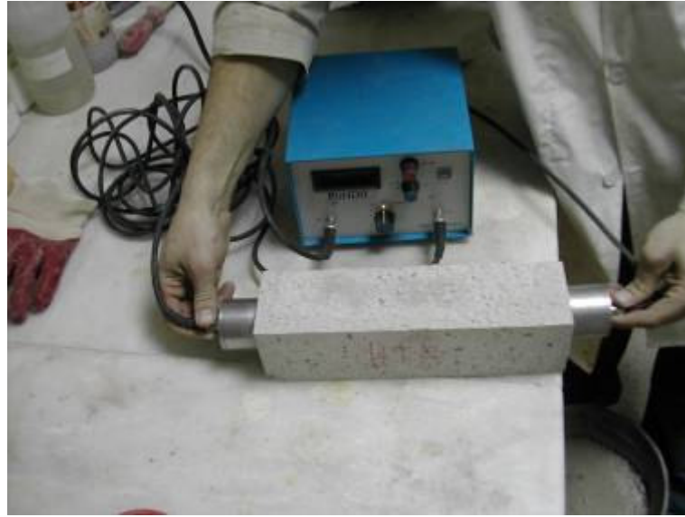
Şekil 9.19 UPV aleti ile kiriş örneklerde ses geçiş hızının ölçülmesi
