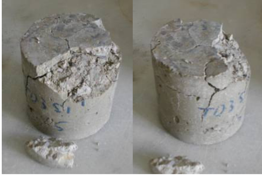
řekil 9.20 Donma-özölme deneyi sonucunda %5 konsantrasyonlu tuz özeltisindeki TK3 örneklerinin durumu
