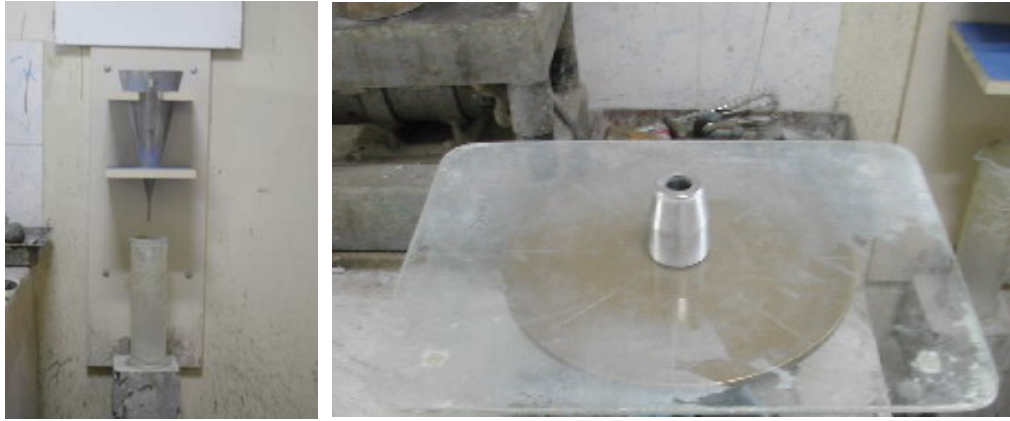
Şekil 6.4 Marsh hunisi ve mini çökme aparatı
