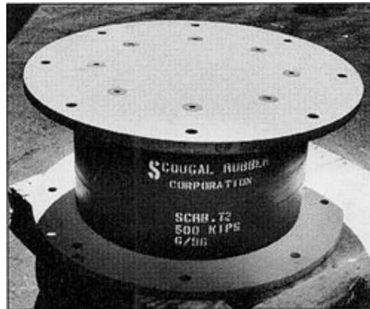
Şekil 2.5 Yüksek sönümlü doğal kauçuk (HITEC, 1999)
