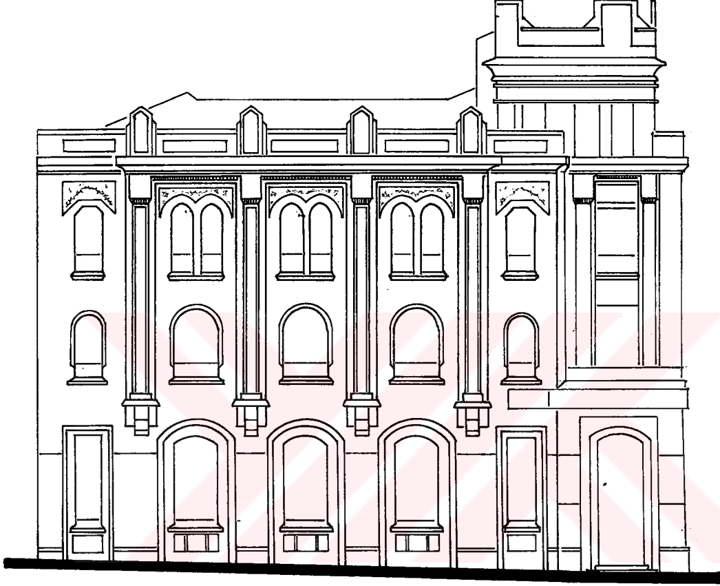
Şekil 4.27 Kuzey cephesi, rölöve
