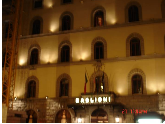
Şekil 4.40 Floransa'da yukarı yönlü, geniş açılı projektörlerin kullanıldığı bir cephe aydınlatma örneği
