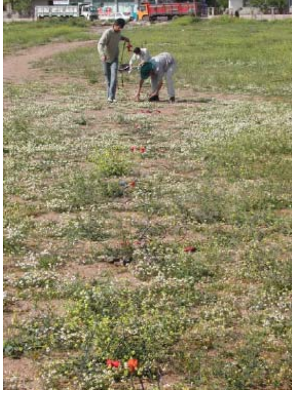
Şekil 4.65 2,5 metre aralıkla jeofonların yerleştirilmesi
