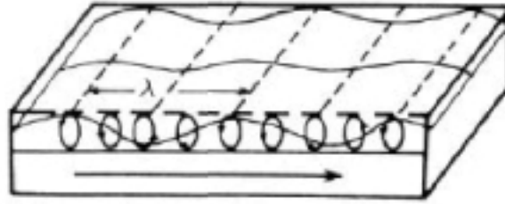
Şekil 3.5 Rayleigh Dalgalarının Yayınımı Sırasında Parçacık Hareketleri.
