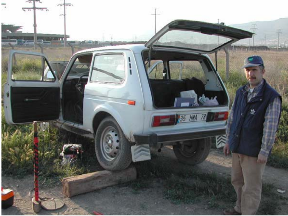
Şekil 4.64 Sismik dalga enerji kaynağı olarak balyozun uygulanması
