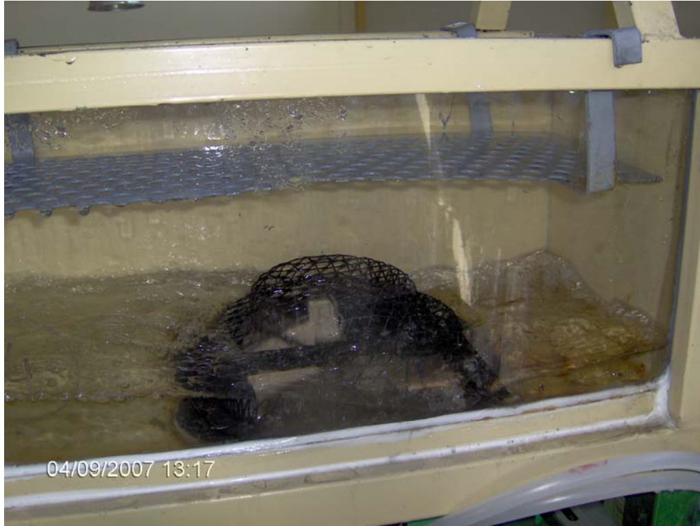
Şekil 4.7 Q = 11,01 \text{ l/s} debisinde gözlenen akım.
