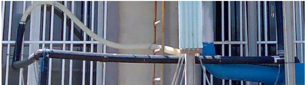
Şekil 5.3 Kayıp katsayılarını belirlemek üzere oluşturulan deney düzeneği.
