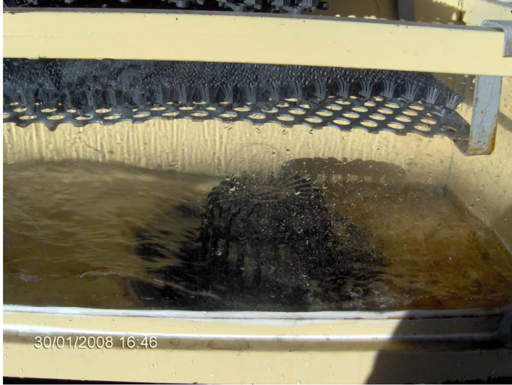
Şekil 4.8 Q = 11,2 l/s debisinde gözlenen akım.
