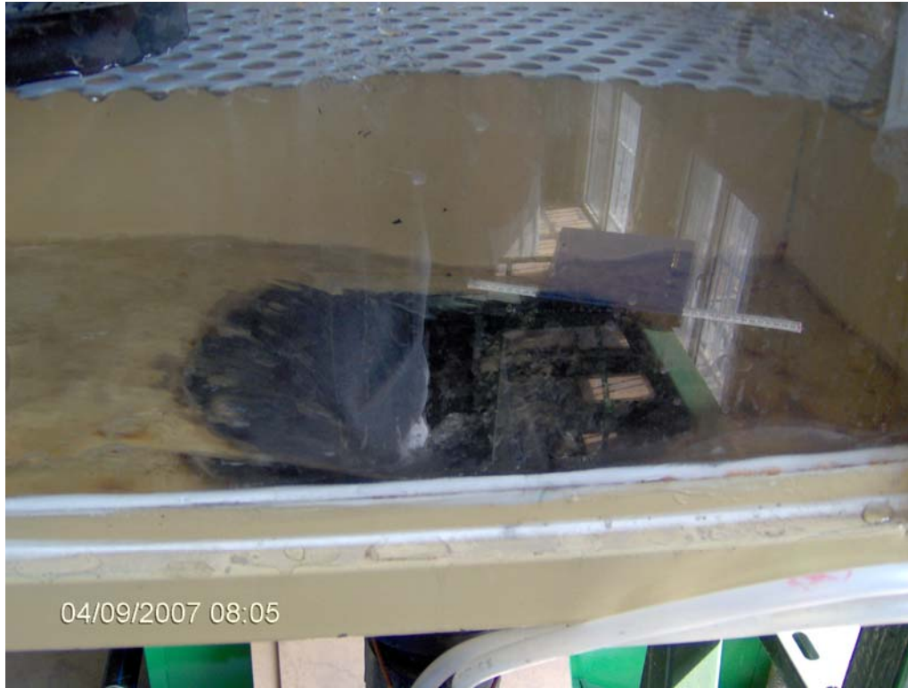
Şekil 4.2 Q = 6,52 l/s debisinde gözlenen akım.
