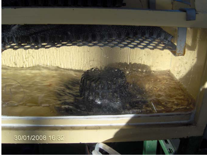
Şekil 4.5 Q = 10,6 l/s debisinde gözlenen akım.
