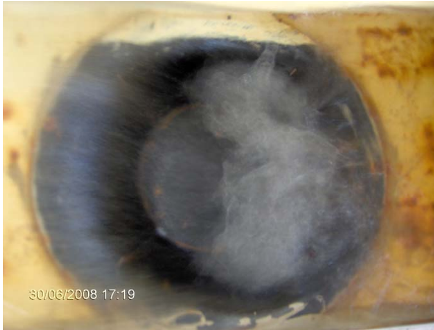
Şekil 4.6 Q = 10,6 l/s debisinde gözlenen akım.
