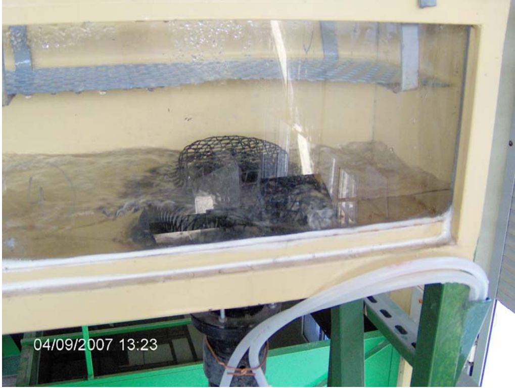
Şekil 4.10 Q = 11,87 l/s debisinde gözlenen akım.
