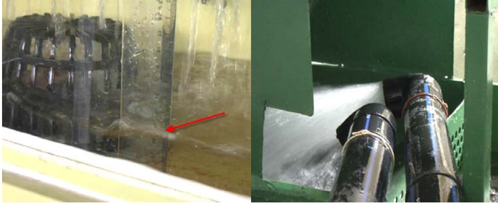
Şekil 4.30 Giriş elemanı ve hat çıkışında gözlenen kararlı akım.
