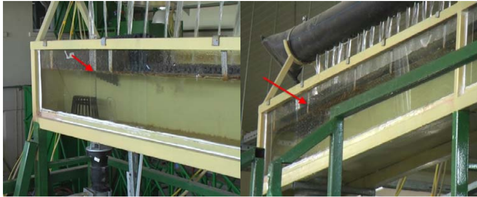
Şekil 4.35 Giriş elemanı üzerinde gözlenen kararlı akım.
