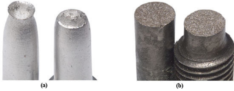
Şekil 4.4 a) Alüminyumun sünek kırılması, b) yumuşak çeliğin gevrek kırılması (Callister, 2007).
