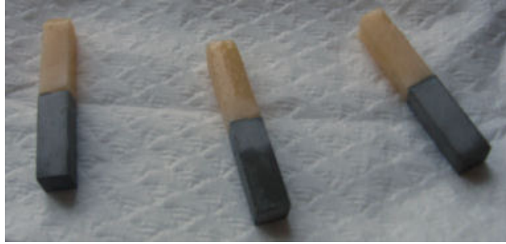
Şekil 6.6 Hazırlanmış üç adet ara yüzey çatlaklı numune.
