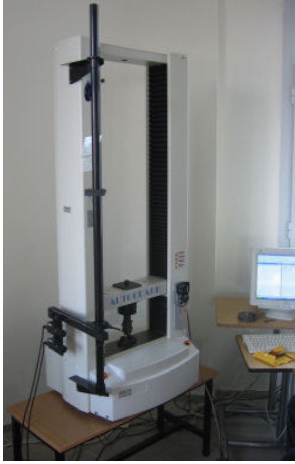
Şekil 6.8 Dört nokta eğme deneyinin yapıldığı universal çeki-bası cihazı.
