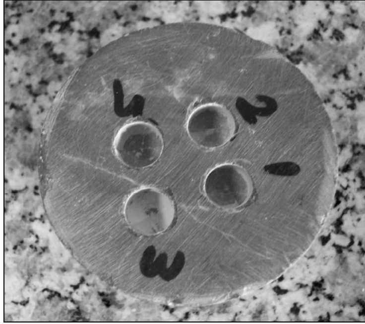
Şekil 3.12 Üzerinde dört delme yapılmış numune
