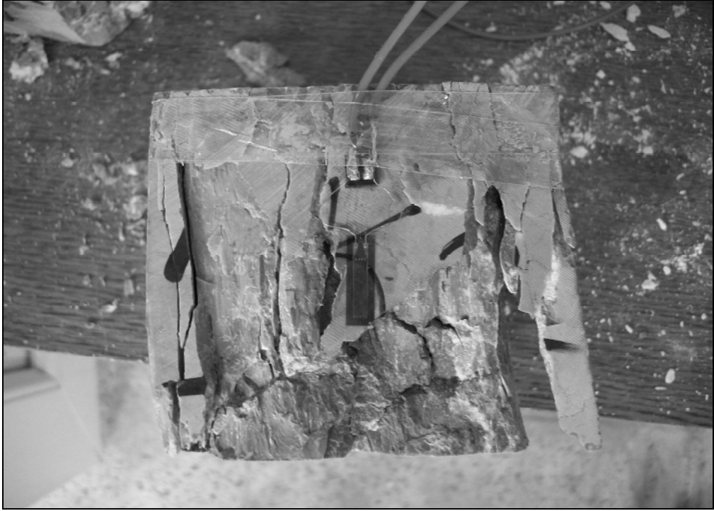
Şekil 3.3 Tek eksenli basınç dayanımı deneyi sonunda numunede meydana gelen kırılmalar
