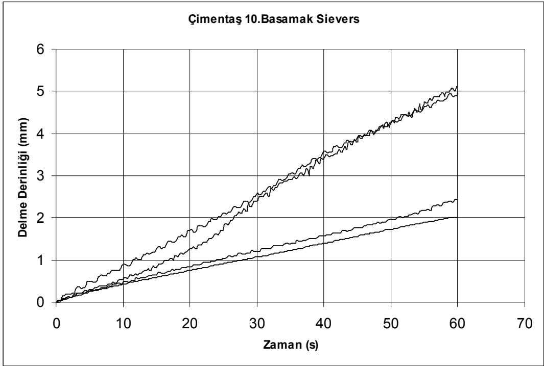
Şekil 4.4 Çimentoş 10. Basamak numunelerinin delinme grafiđi
