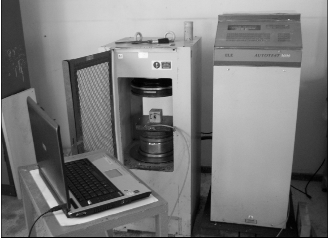
Şekil 3.2 Tek eksenli basınç dayanımı ve deformasyon deney düzeneği
