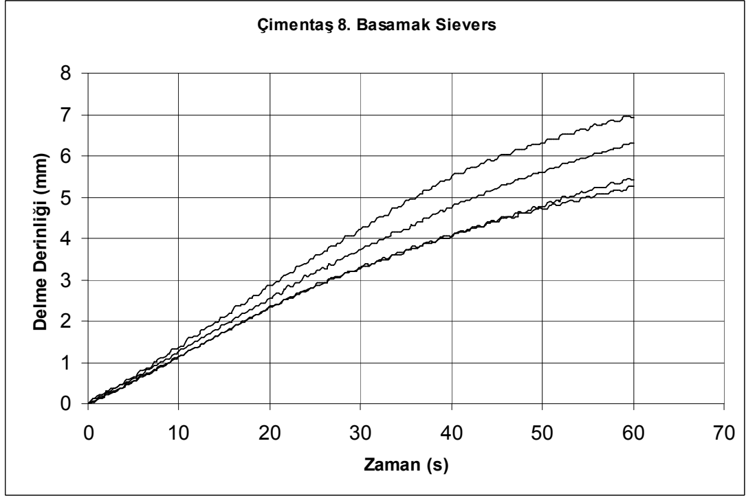
Şekil 4.3 Çimentaş 8. Basamak numunelerinin delinme grafiđi
