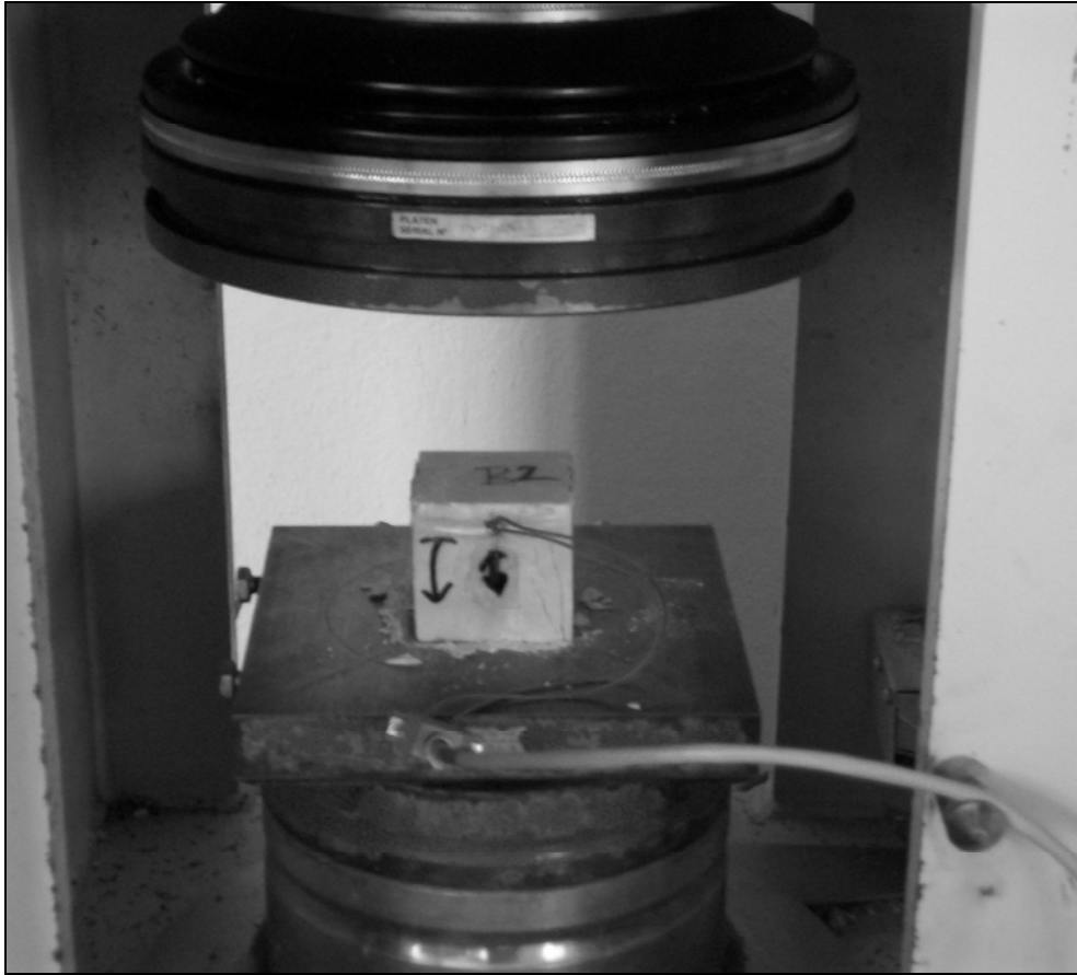
Şekil 3.4 Tek eksenli basınç dayanımı ve deformasyonun ölçülmesi için kurulan düzenek
