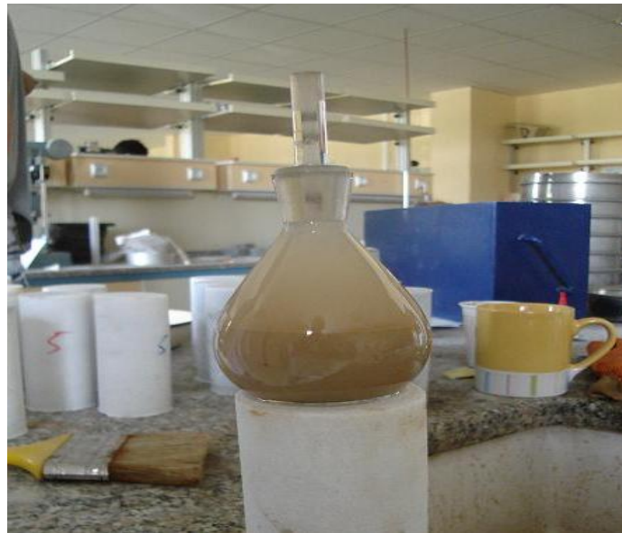
Şekil 3.3 Deneyleerde kullanılan piknometre
