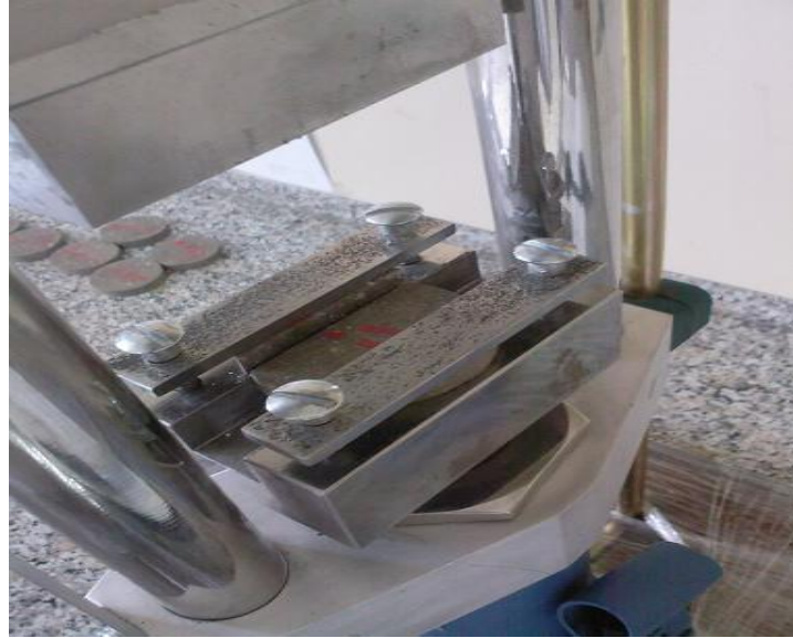
Şekil 3.7 Yükleme başlığı, düzenek ve kırılmış örnek
