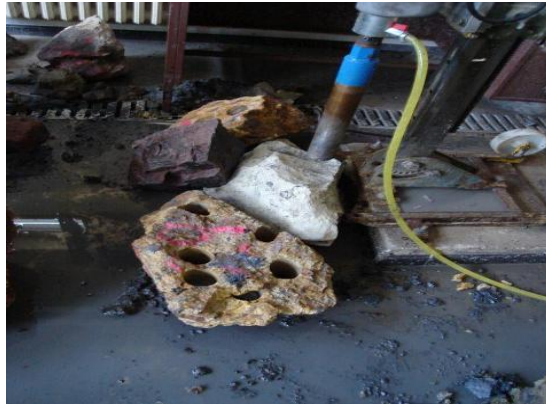
Şekil 3.1 Karot alma makinesi ve numune alma işlemi
