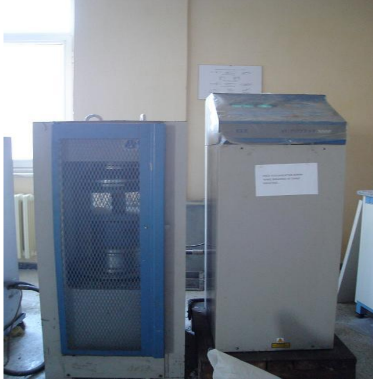
Şekil 3.4 Deneylerde kullanılan 300 ton kapasiteli pres
