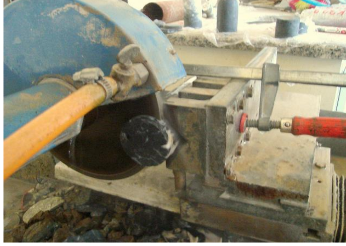
Şekil 3.2 Kafa kesme makinesi ve uygulamasından görüntü
