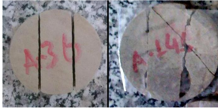
Şekil 3.8 Kırılan düzenli ve düzensiz örnekler
