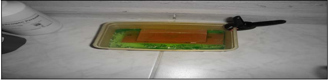
Şekil 6.3 Çözelti içine atılan plaketin bakır olan bölümlerinin erimeye başladığı süreç
