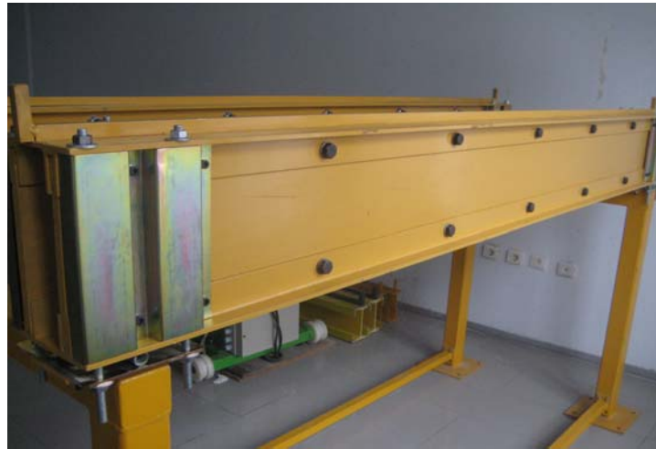
Şekil 6.27 Kirişin basit mesnet davranışı göstermesi için, dairesel boruların yerleştirilmesi
