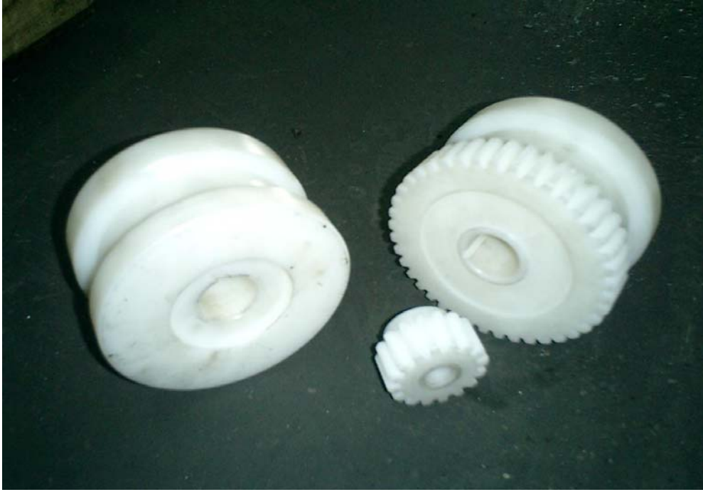
Şekil 5.18 PA6 malzemeden imal edilen pinyon ve araba tekerlekleri(C. Kara, 2008 s.103).
