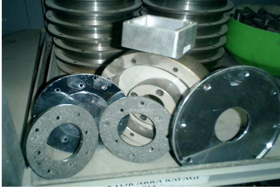
Şekil 5.16 Fren sistemini meydana getiren fren diskleri ve gövdesi(C. Kara, 2008 s.101).
