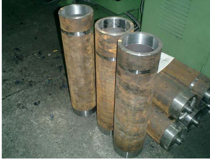
Şekil 5.12 Tanbur gövdelerinin imalat öncesi kılavuzları açılmış (C. Kara, 2008 s.97).
