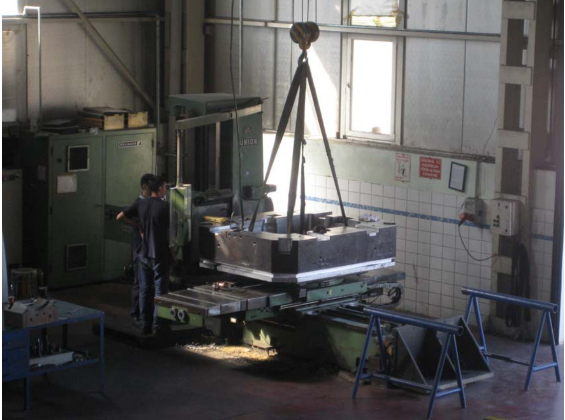
Şekil 5.8 “Double T” profiller üzerindeki deliklerin delinmesinde kullanılan bohrwerk tezgahı.
