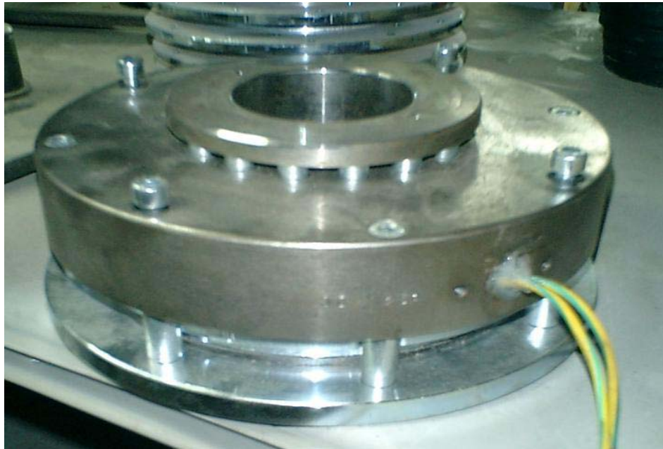
Şekil 5.17 Fren sistemi montajı yapılmış hali(C. Kara, 2008 s.101).
