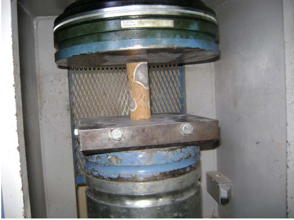
Şekil 1.30 Yükleme plakasının üzerine merkezlenererek ve üst blok ile alt blok arasında boşluk kalmayacak şekilde yerleştirilmiş, yükleme işlemine hazır numune.
