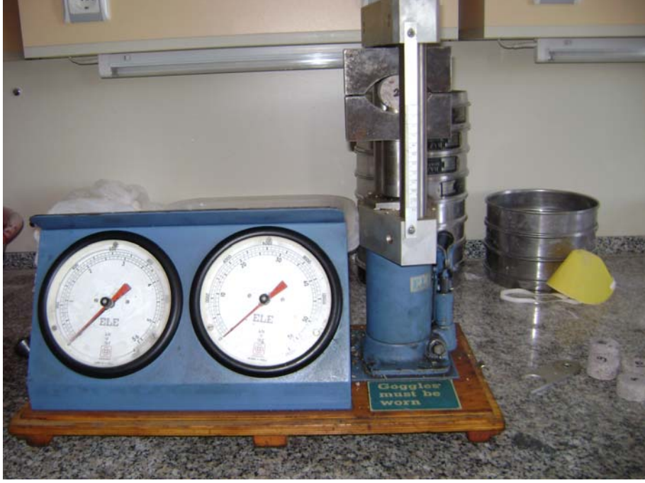
Şekil 2.24 Nokta yükleme aletine monte edilen silindirik plakalar arasına yerleştirilmiş numune.
