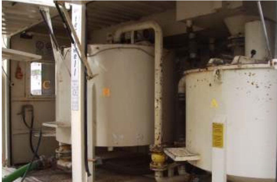
Şekil 4.5 Mikser ünitesi. A karıştırma tankı, B çalkalayıcı tank ve C kumanda odası.
