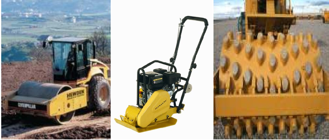
Şekil 2.4 Dolu gövdeli silindir, vibratör ve keçi ayaklı silindire birer örnek ( http://www.hewden.co.uk/_images/cache/pid_026-001.400.400.scale.jpg , http://www.albatooltrading.com , http://www.apolloequipment.net/categories/compactors.htm ).
