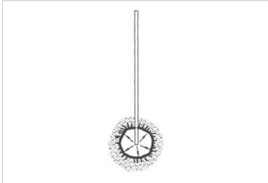
Şekil 2.19 Kompaksiyon enjeksiyonunun şematik gösterimi (Xanthakos ve diğer., 1994).
