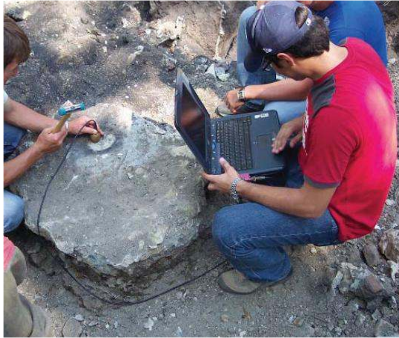
2.27 Kolon süreklilik testi uygulaması (Sağlamer, 2006).
