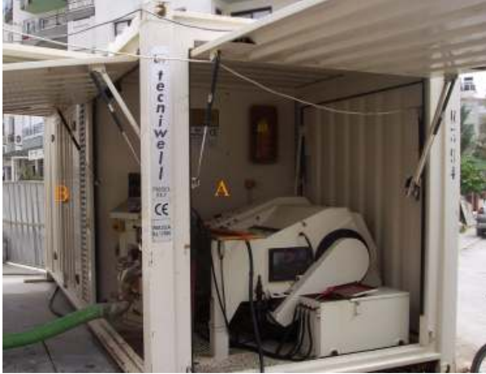
Şekil 4.6 Pompa ünitesi. A pompa kısmı ve B motor kısmı.
