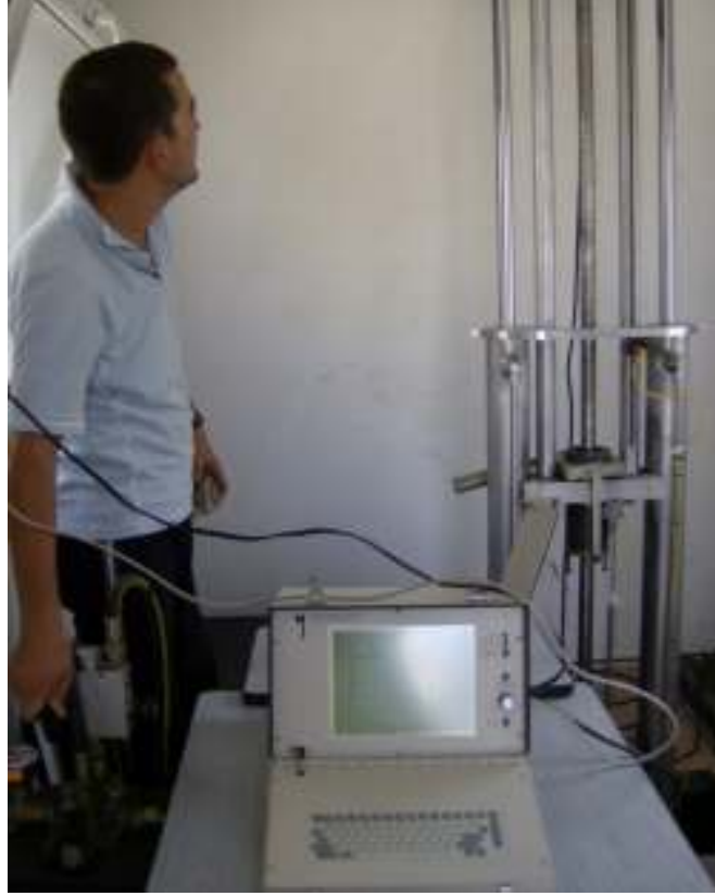
Şekil 3.5 CPT deneyi, konik ucun zemine itilmesi.
