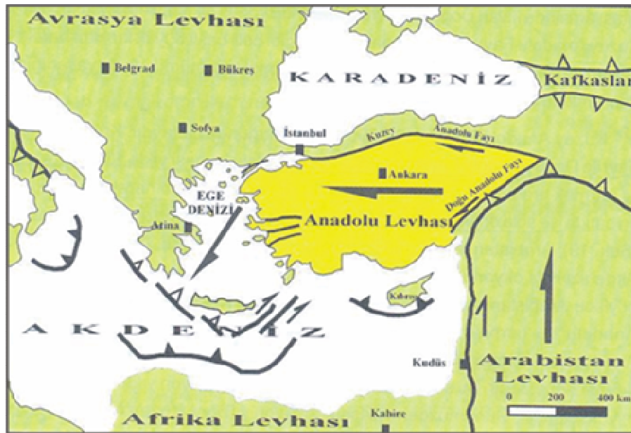
Şekil 3.14 Anadolu Levhasının Batıya Kayışının Mekanizması (MTA, 2000)
