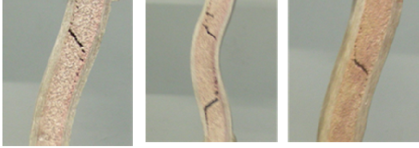
Şekil 3.5 Deney sırasında burkulma örnekleri(sırasıyla; Tip D, B, A)
