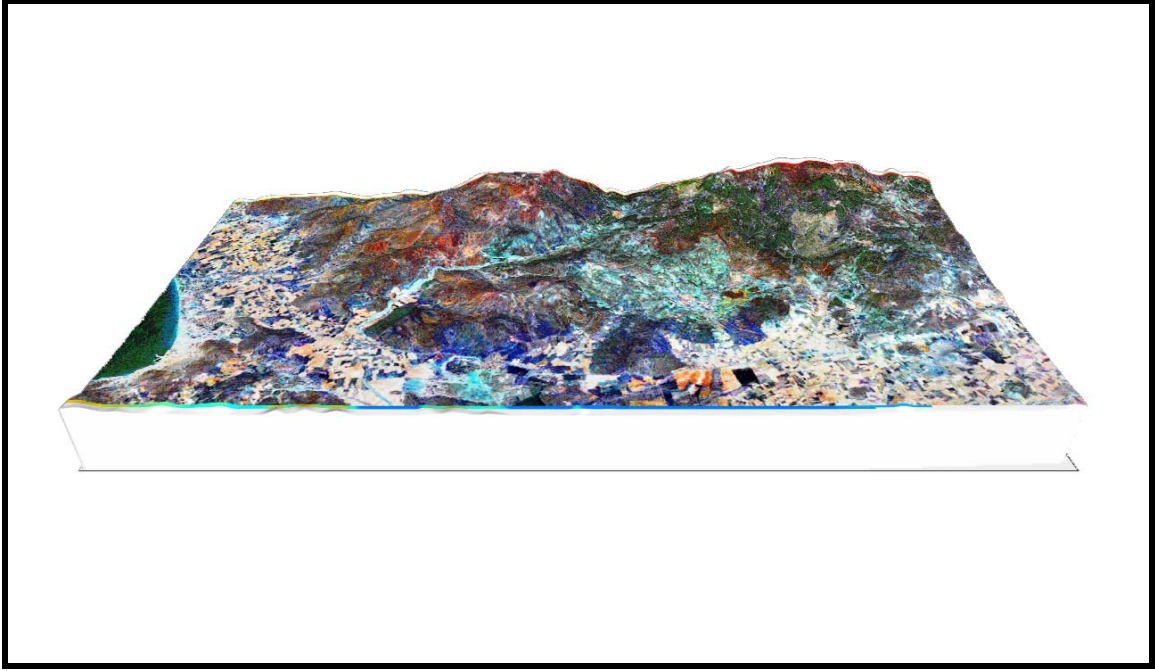
Şekil 5.5 Çalışma alanının Landsat 7 ETM+ RGB 732 görüntüsüne ait bant kombinasyonu kullanılarak Mapinfo 6.5 programında hazırlanmış 3 boyutlu jeolojik birimler görüntüsü.
