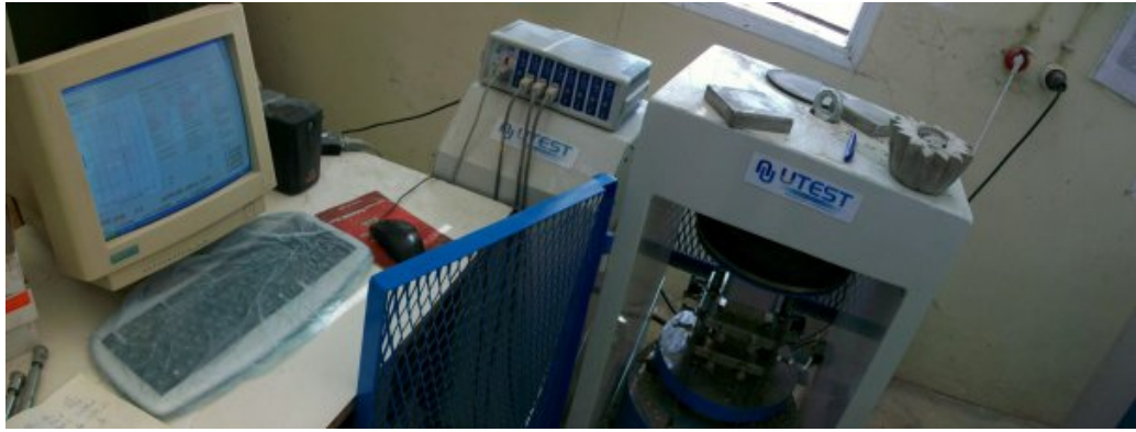
Şekil 5.12 Tek eksenli basınç deney sistemi.
