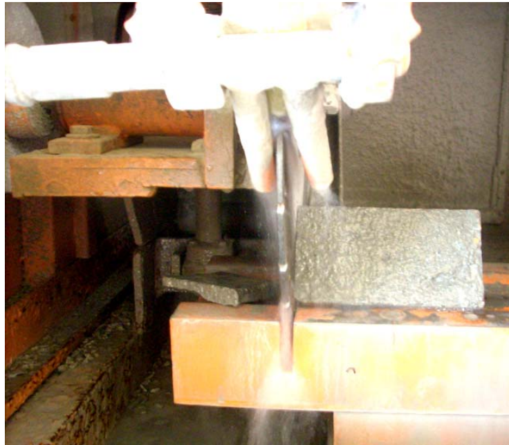
Şekil 5.11 Elmas Bıçak ile Basınç Örneklerinin Hazırlanması
