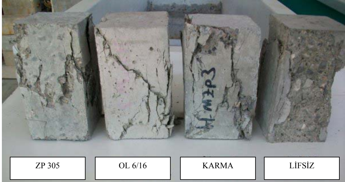
Şekil 7.13 Basınç deneyi sonrası liflerin dağılıma azaltıcı etkisi.
