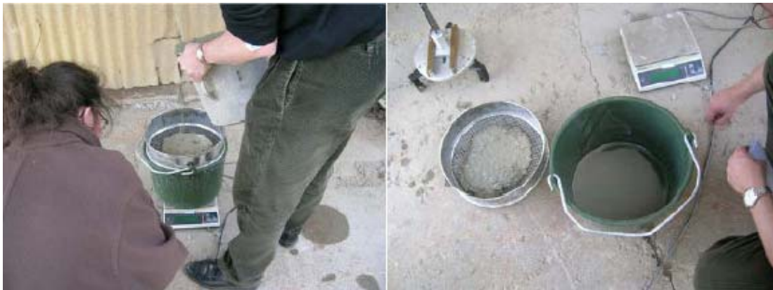
Şekil 1.16 Elek ayrıştırma testinin uygulanması (EFNARC, 2005).
