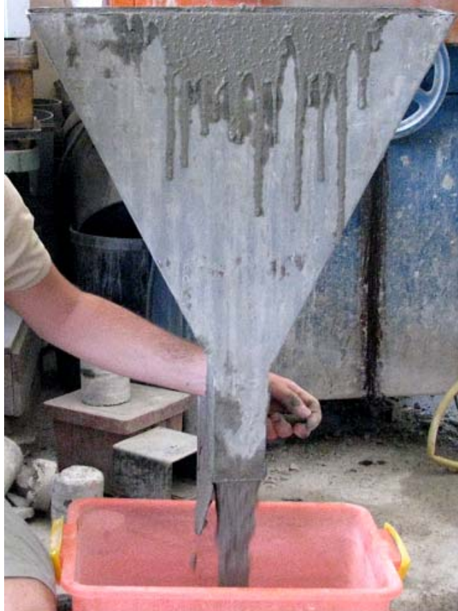
Şekil 5.7 V-kutusu ve akış görüntüsü.
