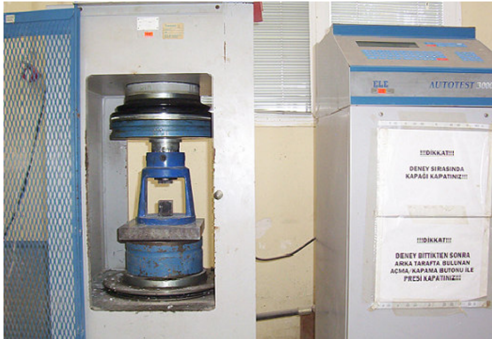
Şekil 3.4 Eğilme sonrası basınç deneyinin yapılıması
