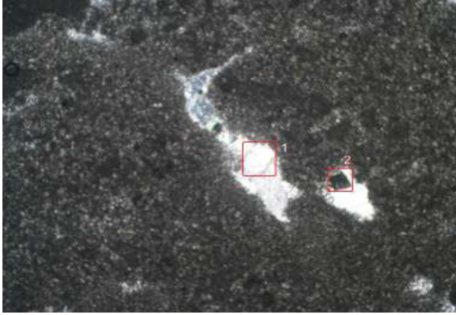
Şekil 5.10 Bir Kanada agregası tanesinde görülen büzülme boşluğu ve dolomit kristali
