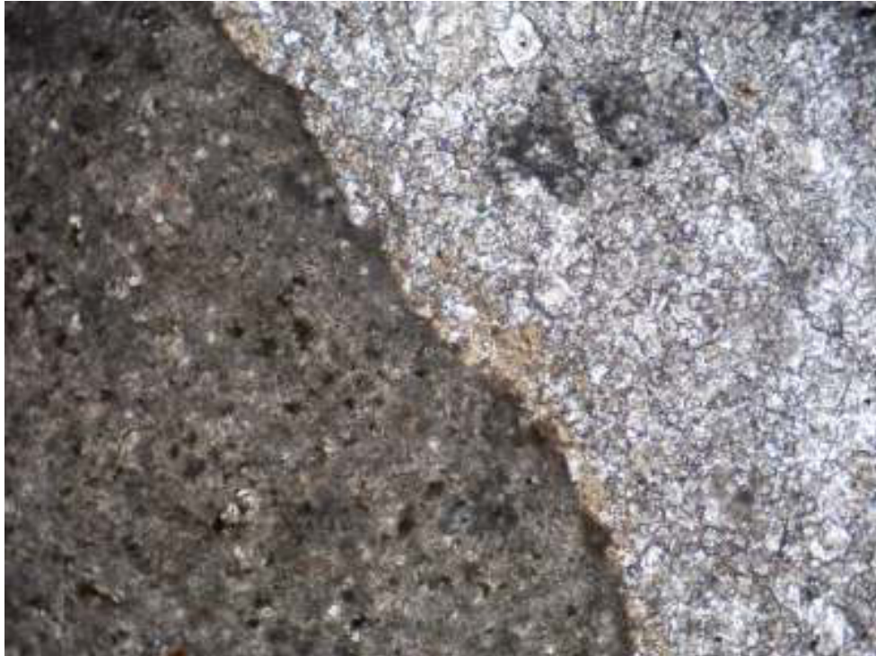
Şekil 5.104 Kanada agregası ile hazırlanan kontrol (mineral katkısız) örnekten çıkarılan ince kesitten, optik mikroskop altında alınmış bir görüntü
