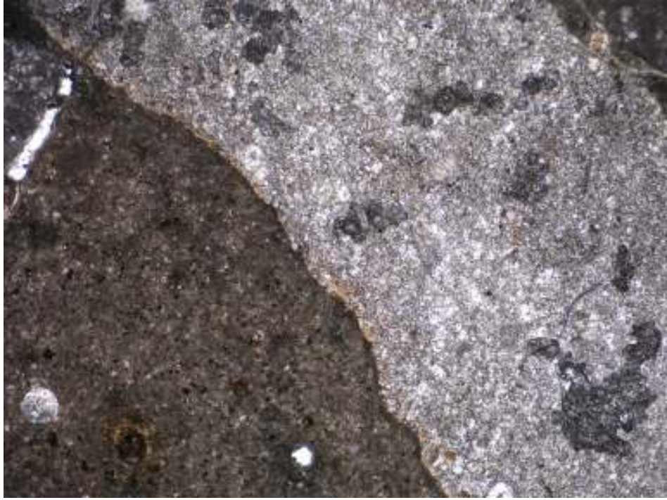
Şekil 5.103 Kanada agregası ile hazırlanan kontrol (mineral katkısız) örnekten çıkarılan ince kesitten, optik mikroskop altında alınmış bir görüntü
