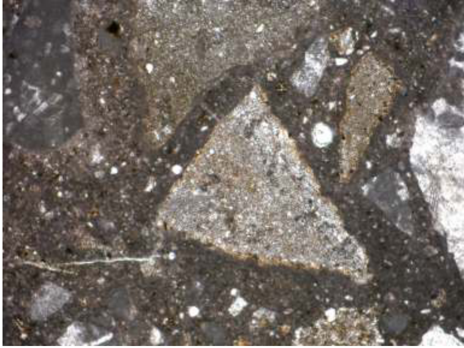
Şekil 5.77 Zonguldak agregası ile hazırlanan kontrol (mineral katkısız) örnekten çıkarılan ince kesitten, optik mikroskop altında alınmış bir görüntü
