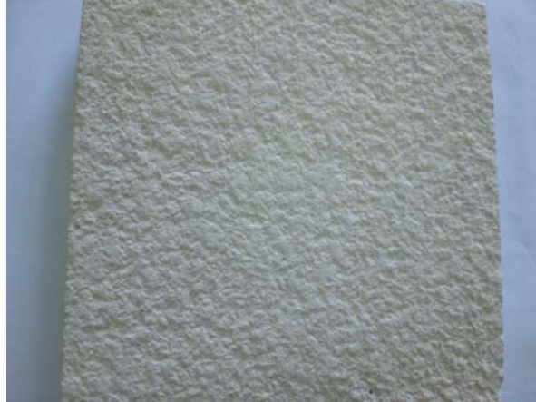
Şekil 3.9 Kumlama işlemi uygulanmış doğal taş yüzeyi
