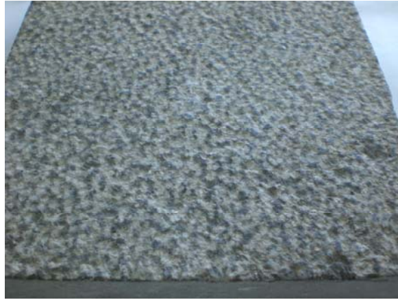
Şekil 3.10 Çekiçleme işlemi uygulanmış doğal taş yüzeyi
