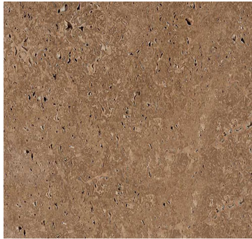
Şekil 3.5 Honlama işlemi uygulanmış doğal taş yüzeyi
