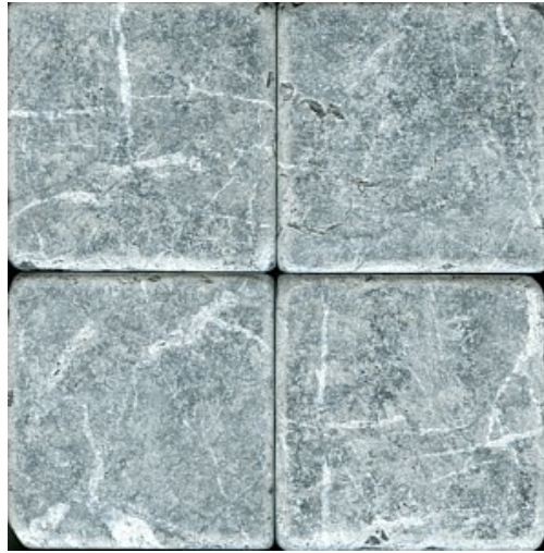
Şekil 3.8 Eskitme işlemi uygulanmış doğal taş yüzeyi
