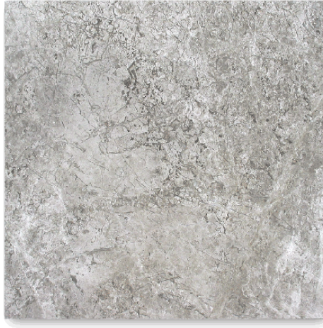
Şekil 3.6 Cilalama işlemi uygulanmış doğal taş yüzeyi
