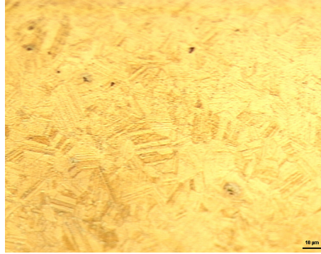
Şekil 4.2 Dağlanmış, implant kalitesindeki CoCrMo alaşımının optik mikroskop ile görüntülenen mikroyapı fotoğrafı (20X).
